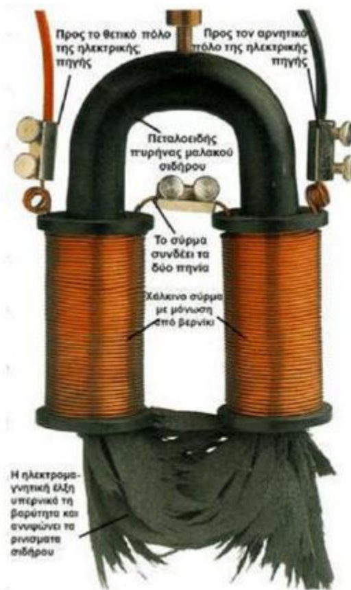
Ηλεκτρομαγνήτης με πυρήνα πεταλοειδή. Φαίνονται τα ρινίσματα σιδήρου που έλκει ο Ηλεκτρομαγνήτης
