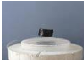
Εικόνα6: Μαγνητική Ανύψωση ενός μαγνήτη πάνω από έναν υπεραγωγό που έχει ψυχθεί σε υγρό άζωτο.
