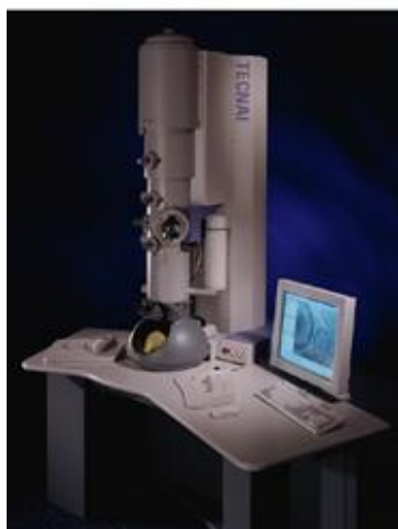
Εικόνα 4.10: Ηλεκτρονικό μικροσκόπιο διέλευσης Tecnai G2 20 XTWIN (FEI, USA).
