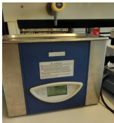
Εικόνα 4.1: Λουτρό υπερήχων που χρησιμοποιήθηκε κατά την πειραματική διαδικασία.
