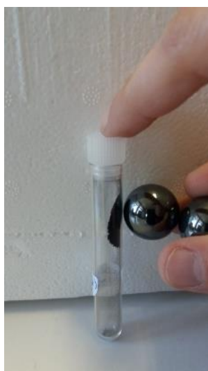
Εικόνα 4.4: Εικόνα του μαγνητικού νανοϋβριδικού υλικού MnFe_2O_4-GO που συντέθηκε μέσω της διαλυτοθερμικής μεθόδου.
