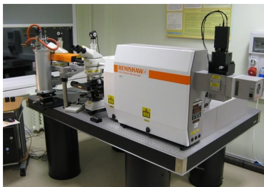
Εικόνα 4.6: Φασματόμετρο microRaman της εταιρείας Renishaw Ramanscope.
