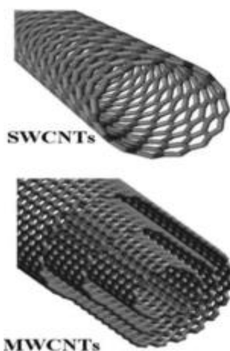
Σχήμα 1.13: Σχηματικές αναπαραστάσεις των SWCNTs και MWCNTs. 13
