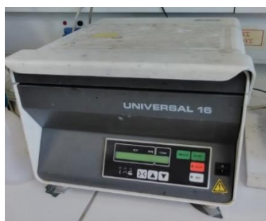
Εικόνα 4.2: Συσκευή φυγοκέντρωσης που χρησιμοποιήθηκε κατά την πειραματική διαδικασία.
