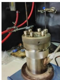
Εικόνα 4.3: Αυτόκλειστο δοχείο από ανοξείδωτο χάλυβα που χρησιμοποιήθηκε κατά τη διαδικασία σύνθεσης των νανοϋβριδικών υλικών MnFe_2O_4-GO .
