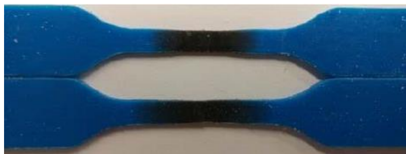
Εικόνα 25: Δοκίμια εφελκυσμού κατασκευασμένα από διαφορετικά είδη εμπορικών υλικών (TangoBlackPlus και VeroCyan) για ψεκασμό υλικού με διαβάθμιση στη σύσταση.
