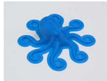
Εικόνα 24: Κατασκευασμένο δείγμα με brim για υπόστρωμα
