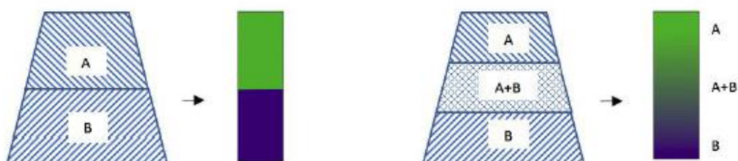
Εικόνα 10: Σχήμα στα αριστερά, αναπαράσταση συμβατικής μεθόδου ΠΚ με πολλαπλά υλικά. Σχήμα στα δεξιά, αναπαράσταση εκτύπωσης με πολλαπλά υλικά με την FGAM.
