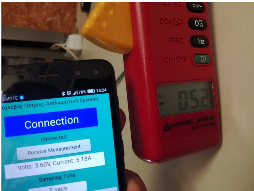
Εικόνα 44: Μέτρηση ρεύματος με αμπεροτσιμπίδα και την χρήση της διάταξης κατά την διάρκεια του ελέγχου.
