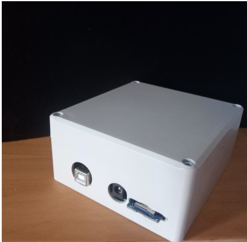
Εικόνα 27: Γενική άποψη της διάταξης και των υποδοχών USB, τροφοδοσίας και εισόδου της κάρτας microSD
