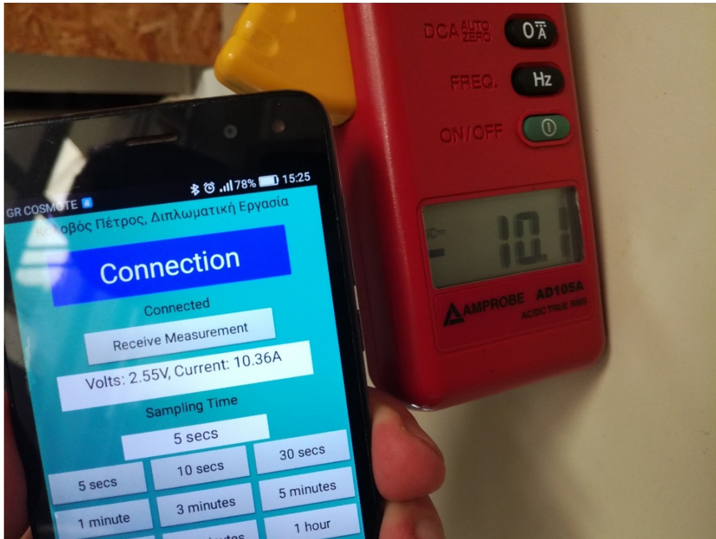
Εικόνα 43: Μέτρηση ρεύματος με αμπεροτσιμπίδα και την χρήση της διάταξης κατά την διάρκεια του ελέγχου.
