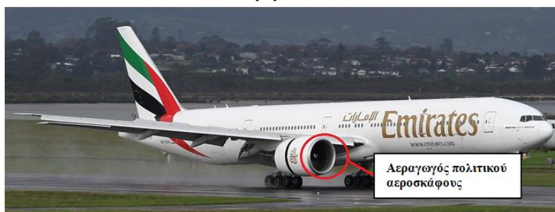
Σχ. 4.11 Εικόνες αεραγωγού (air-inlet) (α)μαχητικού και (β)πολιτικού αεροσκάφους
