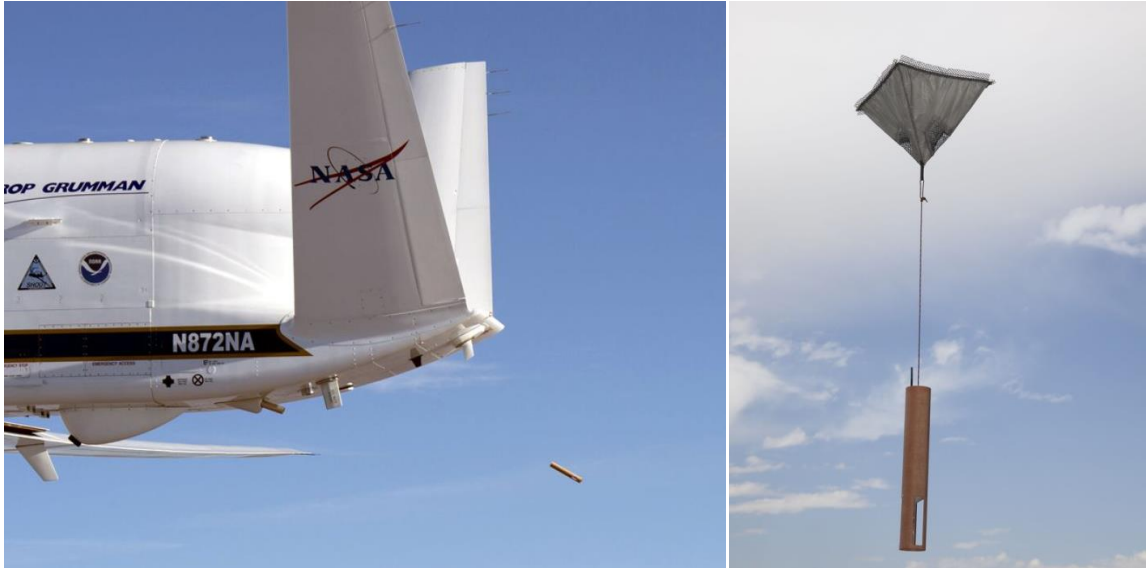
Σχήμα 3.7: (Αριστερά) Το αεροσκάφος Global Hawk της NASA απελευθερώνει Ραδιοβολίδα “dropsonde”. (Δεξιά) Η ραδιοβολίδα “dropsonde” εν πτήση [ https://www.google.com/search?rlz=1C1GCEA_enGR867GR867&q=dropsonde+photos&tbm=isch&source=univ&sa=X&ved=2ahUKEwiQv_X7jvzIAhWwxMQBHQ37BJkQsAR6BAgKEAE&biw=1536&bih=722 ].
