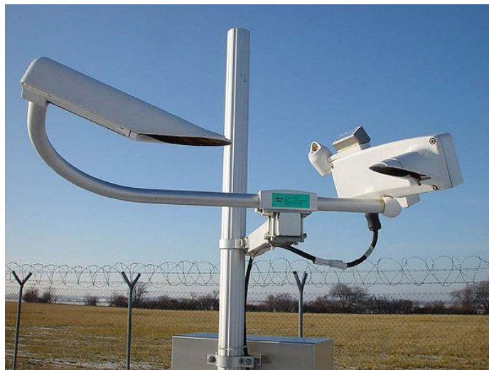
Σχήμα 3.3: Εμπρόσθιος σκεδαστομετρητής διαδρόμου αεροδρομίου AGVIS FSI ( https://wikivisually.com/wiki/Scatterometer ).
