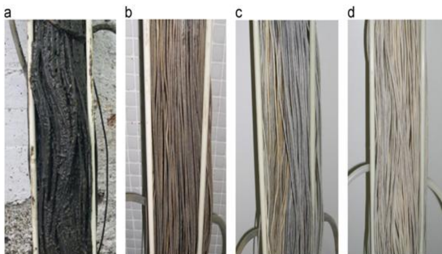
Εικόνα 20: Στάδια χημικού καθαρισμού βυθιζόμενης μεμβράνης κοίλων ινών PVDF (Ramos et al, 2007).
