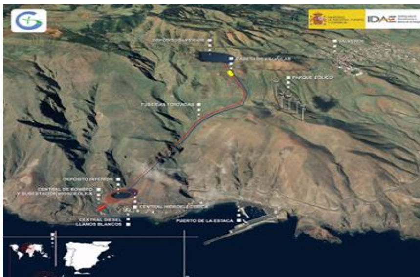
Σχήμα 2.42 Σχηματική απεικόνιση μονάδας αντλησιοταμίευσης στο El Hierro στα Κανάρια νησιά
