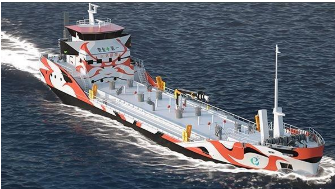
ηλεκτρικό tanker e5
