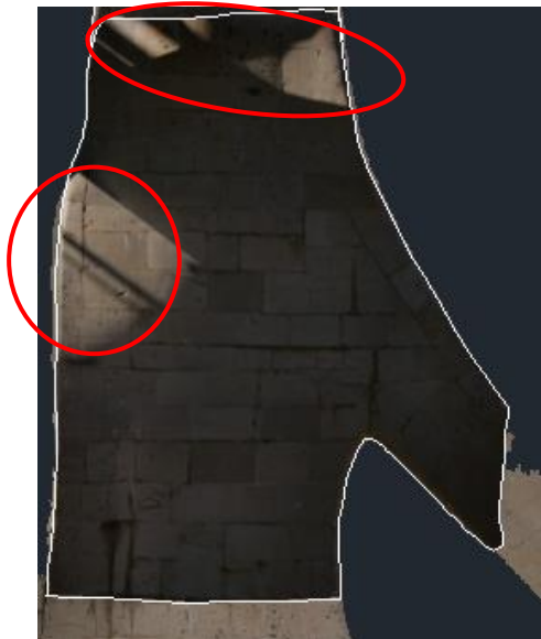
Εικόνα 4 - 109: Ραδιομετρικά προβλήματα στην ορθοφωτογραφία της δεύτερης μορφής
