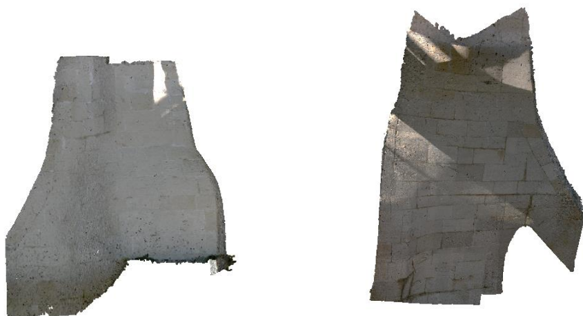
Εικόνα 4 - 52: Πυκνό νέφος σημείων – chunk 4 Εικόνα 4 - 53: Πυκνό νέφος σημείων – chunk 7
