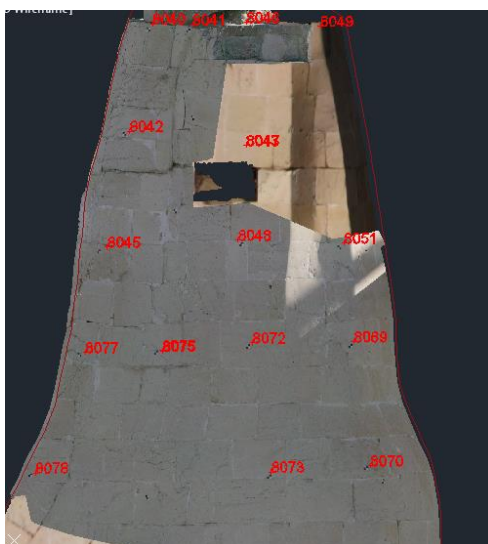
Εικόνα 4 - 102: Φωτοσταθερά στο νέο ορθοφωτομωσαϊκό στο επίπεδο B'-B
