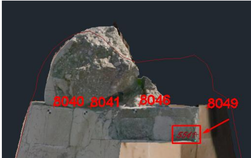
Εικόνα 4 - 105: Πρόβλημα σε φωτοσταθερό στο νέο ορθοφωτομωσαϊκό στο επιπέδο Β'-Β
