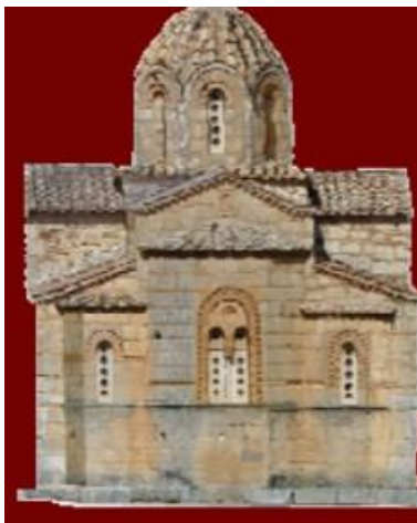
Εικόνα 3 - 9: Ορθοφωτογραφία και τρισδιάστατο μοντέλο βυζαντινής εκκλησίας
