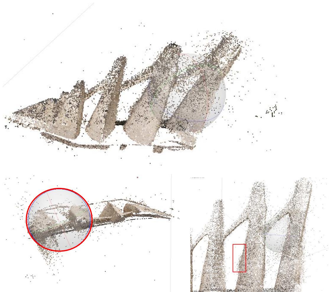
Εικόνα 4 - 15: Προβλήματα του alignment στο chunk 1
