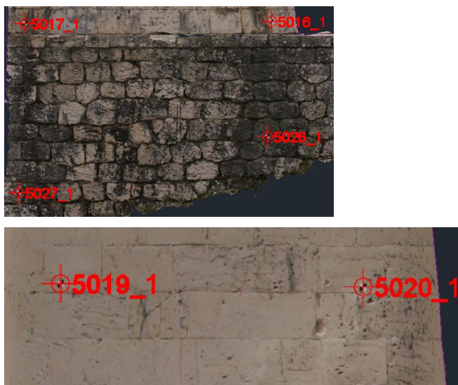
Εικόνα 4 - 90: Φωτοσταθερά στο νέο ορθοφωτομωσαϊκό στο επίπεδο A-A'
