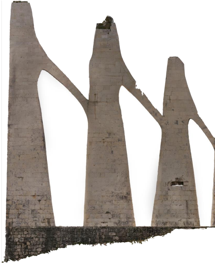
Εικόνα 4 - 110: Ορθοφωτομωσαϊκό έπειτα από τη ραδιομετρική εξομάλυνση
