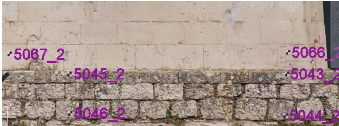
Εικόνα 4 - 99: Φωτοσταθερά στο νέο ορθοφωτομωσαϊκό στο επίπεδο Β''-Β'
