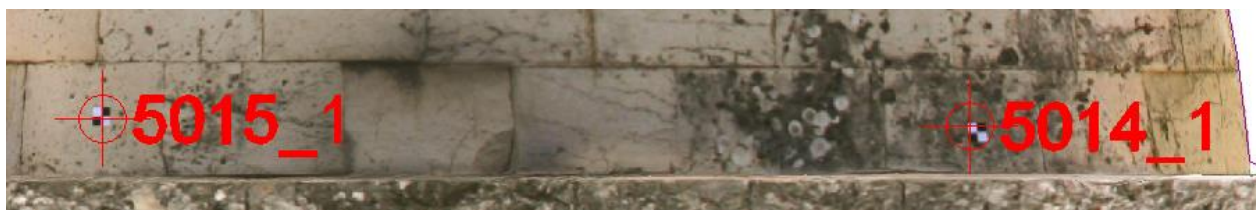
Εικόνα 5 - 34: Παλιά ορθοφωτογραφία - φωτοσταθερά
