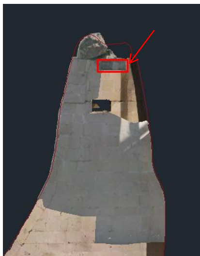
Εικόνα 4 - 101: Προβλήματα στο ορθοφωτομωσαϊκό του επιπέδου B'-B
