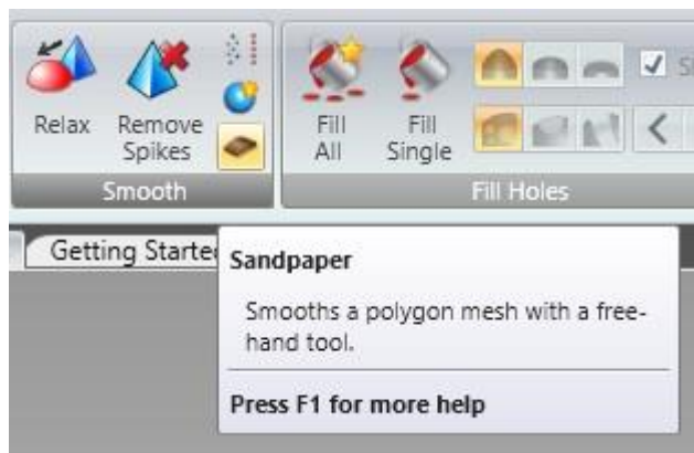
Εικόνα 4 - 68: Εντολή ομαλοποίησης στο πρόγραμμα Geomagic Wrap
