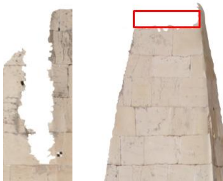
Εικόνα 4 - 96: Ελλείψεις στην ορθοφωτογραφία του επιπέδου Β''-Β'
