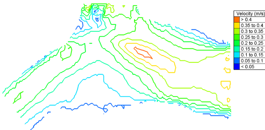
Εικόνα 5.1-2: Ισοδυναμικές γραμμές της διακύμανσης της ταχύτητας του νερού στο πεδίο ροής.
