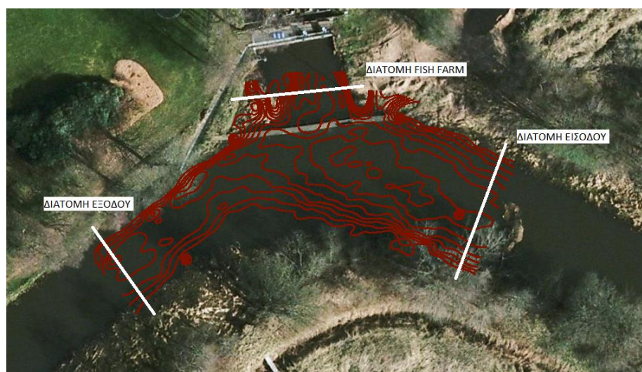
Εικόνα 3.3-4: Διακύμανση μέσης ταχύτητας από τις μετρήσεις στο πεδίο γραμμές [πηγή: Svendsen et al., 2011]. Οι διατομές στις εισόδους και εξόδους φαίνονται με λευκές γραμμές.
