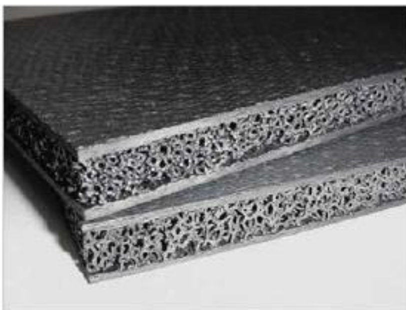
Εικόνα 28: Μονωμένο πάνελ με αυξητικούς μεταλλικούς αφρούς [70]
