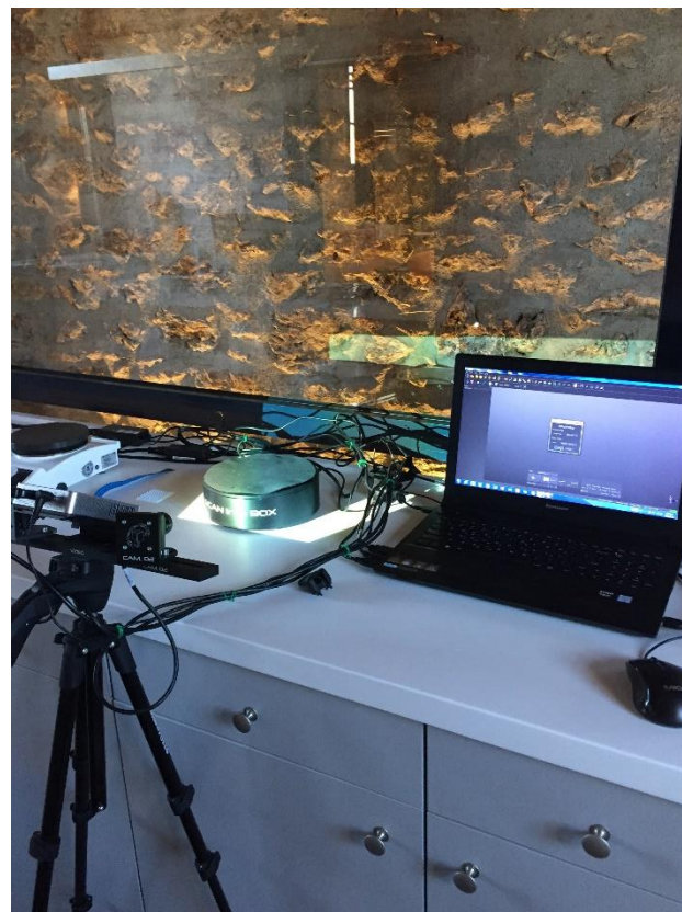
Εικόνα 41: Απαραίτητο calibration της κάμερας και της περιστροφικής τράπεζας για να ξεκινήσει η σάρωση των αντικειμένων
