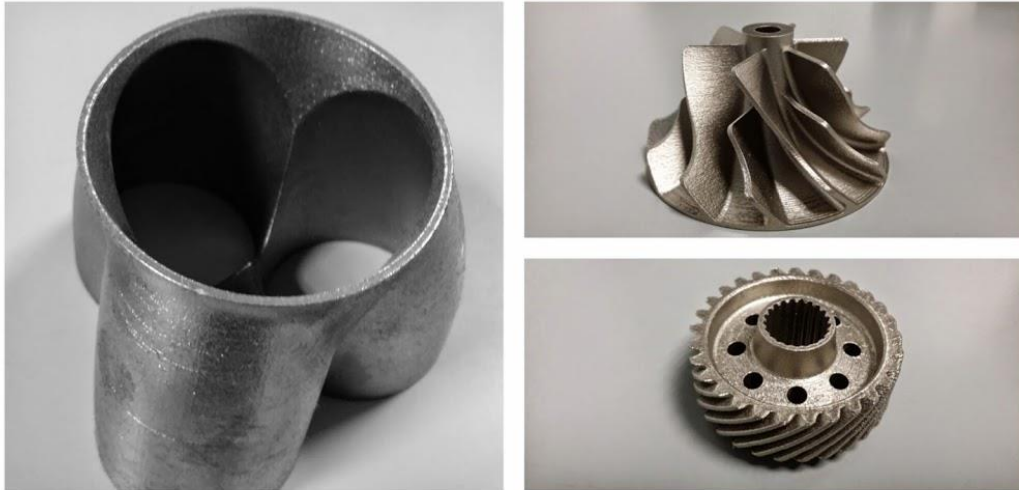
Εικόνα 32: Πολύπλοκες γεωμετρίες εκτυπωμένες με την τεχνολογία της τριδιάστατης εκτύπωσης για την αυτοκινητοβιομηχανία. [66]
