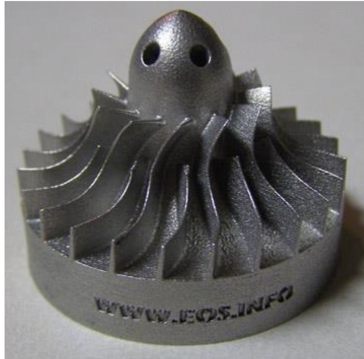
Εικόνα 31: Τριδιάστατη εκτυπωμένη μινιατούρα τουρμπίνας από Rapid 2006 στο Σικάγο, Ιλινόις. [65]
