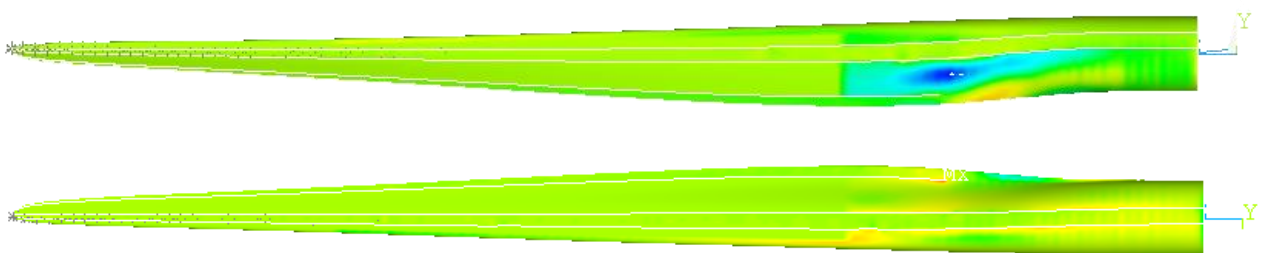
Διάγραμμα 57: Η κατανομή των ορθών τάσεων κατά τον άξονα X της τέταρτης στρώσης του πτερυγίου.
