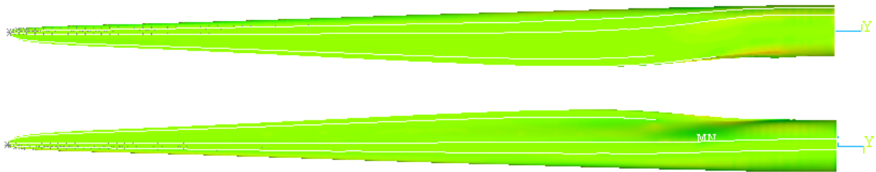
Διάγραμμα 52: Η κατανομή των ορθών τάσεων κατά τον άξονα Y της πρώτης στρώσης του πτερυγίου.
