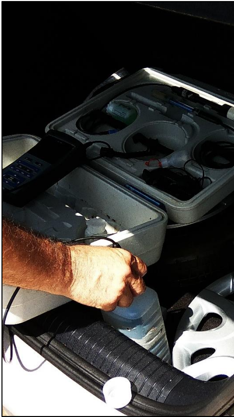
Σχήμα 36. Πολυπαραμετρικό όργανο επί τόπου ανάλυσης φυσικοχημικών χαρακτηριστικών νερού.
