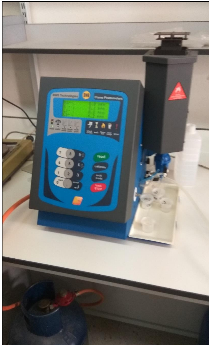
Σχήμα 38. Φλογοφωτόμετρο για μέτρηση συγκέντρωσης ιόντων K^+ και Na^+ .
