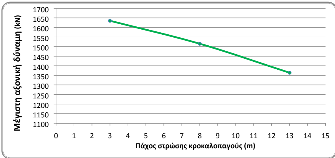
Εικόνα 66: Μέγιστες αξονικές δυνάμεις επί του διαφραγματικού τοίχου συναρτήσει του πάχους στρώσης του κροκαλοπαγούς.
