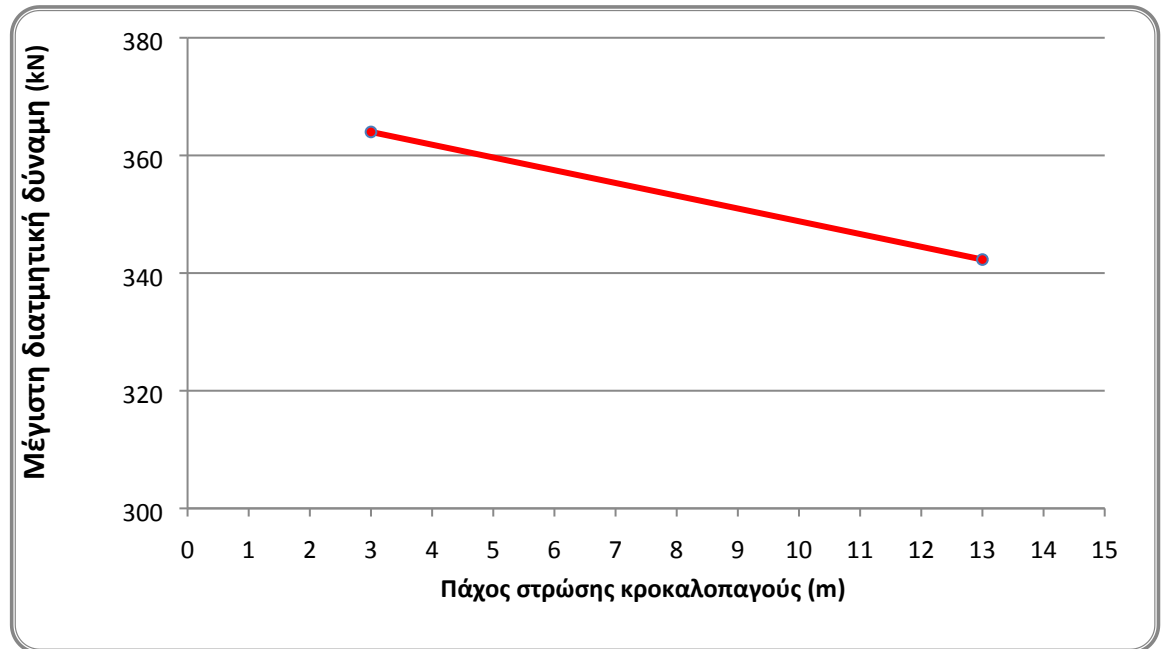
Εικόνα 134:Μέγιστες διατμητικές δυνάμεις επί του διαφραγματικού τοίχου σε συνάρτηση με το πάχος στρώσης του κροκαλοπαγούς.
