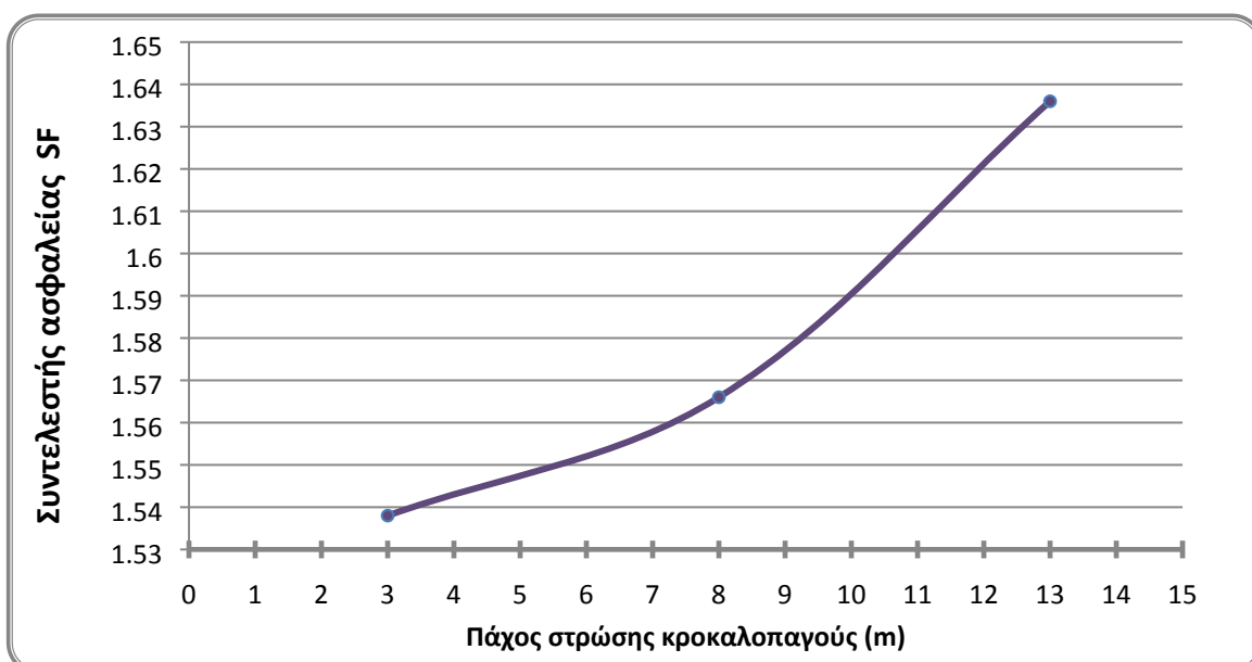
Εικόνα 69: Τιμές του συντελεστή ασφαλείας συναρτήσει του πάχους στρώσης του κροκαλοπαγούς.
