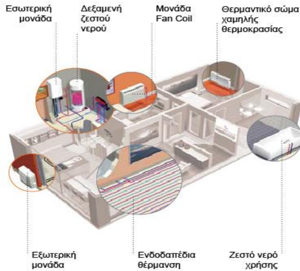
Εικόνα 5.7 Ολοκληρωμένο σύστημα αεροθερμικής αντλίας θερμότητας (πηγή: idealklima).
