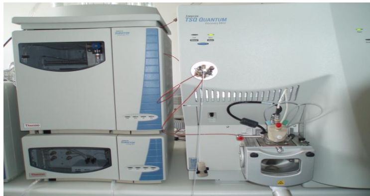
Σχήμα 5.1. Υγρός χρωματογράφος με ανιχνευτή φασματογράφο μάζας τεχνολογίας τριπλού τετραπόλου και πηγή ιοντισμού ηλεκτροψεκασμού, LC-ESI-MS/MS (Thermo Finnigan)
