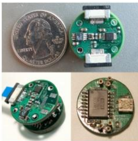
Εικόνα 3.6: Ηλεκτρόδιο χωρίς ηλεκτρική επαφή με το δέρμα [30]
