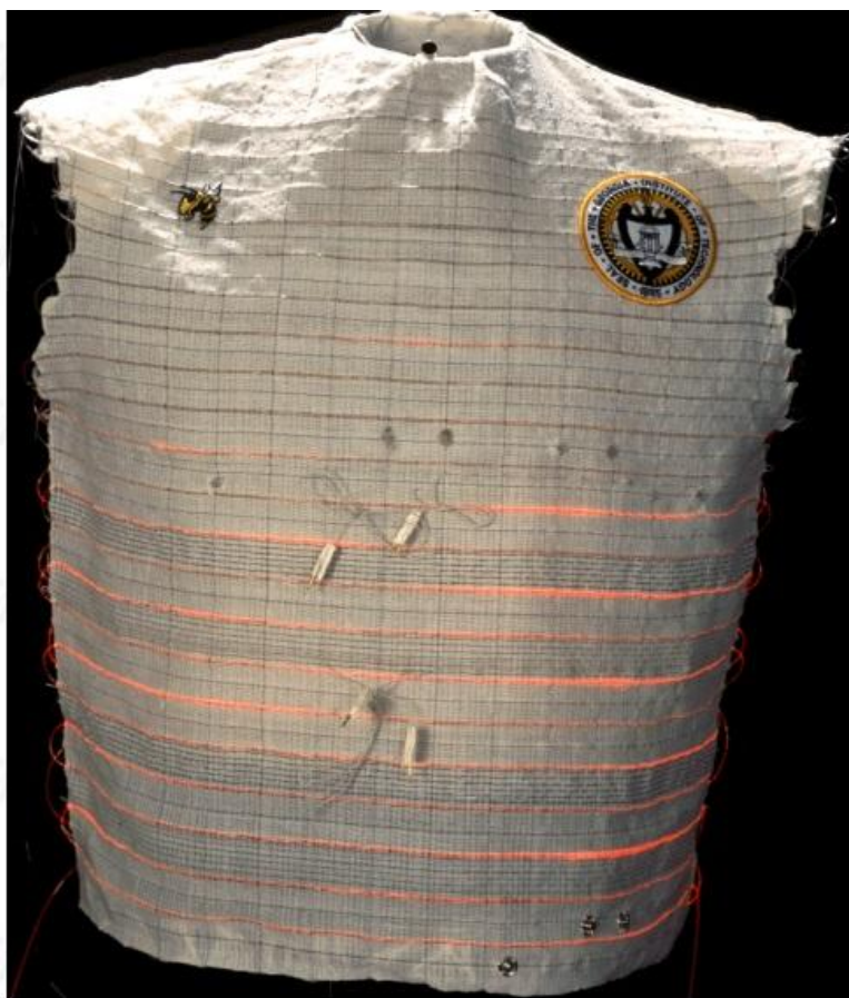
Εικόνα 3.12: Το ‘έξυπνο μπλουζάκι’ Georgia Tech Wearable Motherboard™ [34]
