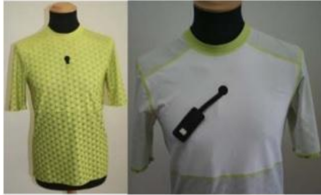
Εικόνα 3.21: Το My Wear T-Shirt με αισθητήρες μέτρησης ρυθμού αναπνοής [39]
