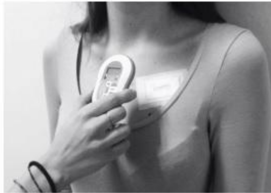
Εικόνα 3.3: Επιδερμικό θερμόμετρο τοποθετημένο στο στήθος του ατόμου και αποστολή δεδομένων στη συσκευή συλλογής και ανάγνωσης [28]
