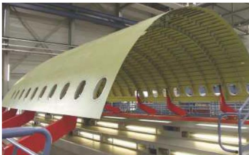
Εικόνα 1.40 Ολοκληρωμένο τμήμα ατράκτου Airbus A-380 από Glare
