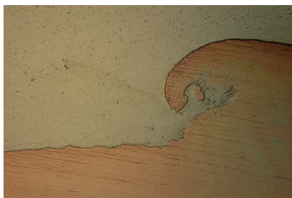
Εικόνα 6.20: Δοκίμιο Νο4, αρχή συγκόλλησης, 4 ο πάσο, φακός x5
