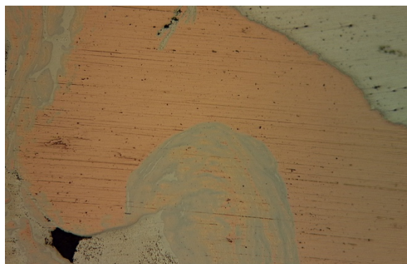
Εικόνα 6.18: Δοκίμιο Νο4, αρχή συγκόλλησης, 2 ο πάσο, φακός x5
