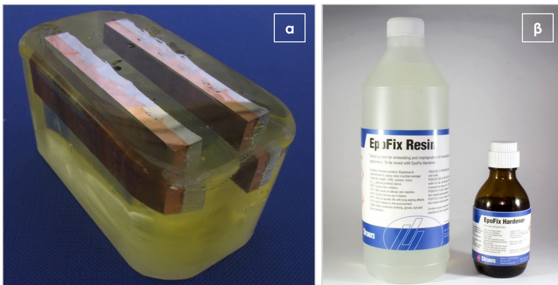
Εικόνα 5.5: (α) Εγκιβωτισμένα δοκίμια, (β) Struers EpoFix Resin & Hardener
