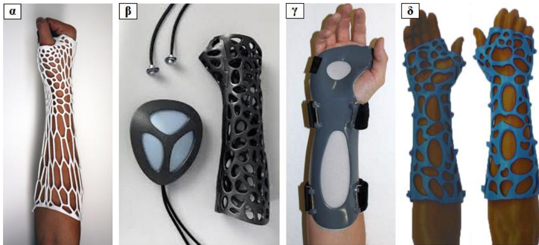
Εικόνα 2.6: Τρισδιάστατα εκτυπωμένοι νάρθηκες άνω άκρων: (α) Cortex [46], (β) Osteoid [47], (γ) μοντέλο νάρθηκα που αναπτύχθηκε από τους Palousek et al. [50] και (δ) μοντέλο νάρθηκα που αναπτύχθηκε από τους Blaya et al. [7].
