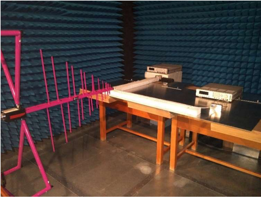
Σχήμα 16 - Υλοποίηση βασικής διάταξης μέτρησης ακτινοβολούμενων εκπομπών ηλεκτρικού πεδίου (κεραία/καλώδιο)
