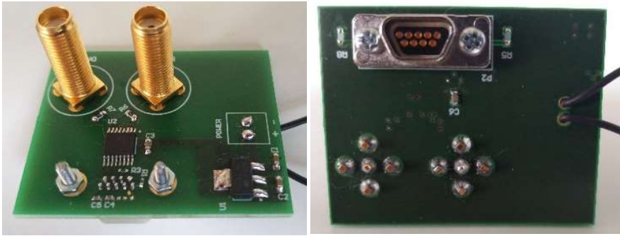
Σχήμα 18 - Υλοποίηση τυπωμένου κυκλώματος (PCB) οδηγού LVDS
