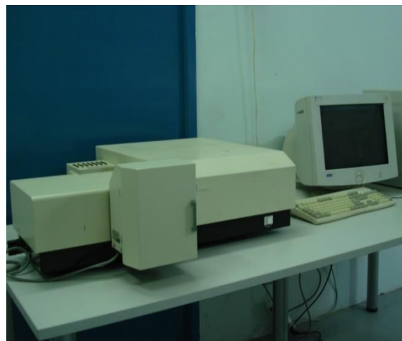
Σχήμα 5.1.10. Σχηματική παράσταση ροών για συμπαγές υλικό (αριστερά) και το φασματοφωτόμετρο UV-2100 της Shimadzu (δεξιά).
