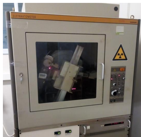
Σχήμα 5.1.1. Η αρχή λειτουργίας (αριστερά) του περιθλασίμετρου D500 της Siemens (δεξιά).
