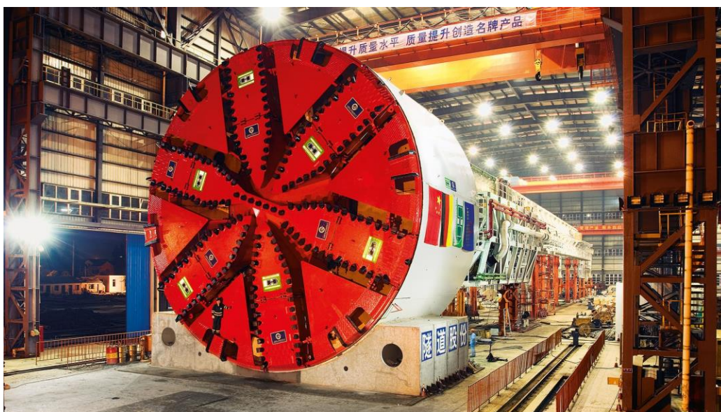
Εικόνα 2. 5. Κοπτική κεφαλή TBM (Πηγή: Herrenknecht AG).
