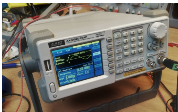
Σχήμα 2.4: Σχήμα της γεννήτριας συχνοτήτων που χρησιμοποιήθηκε
