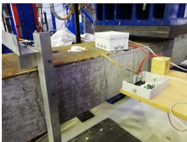
Σχήμα 2.6: Αισθητήρας στο μέσο της δοκού
