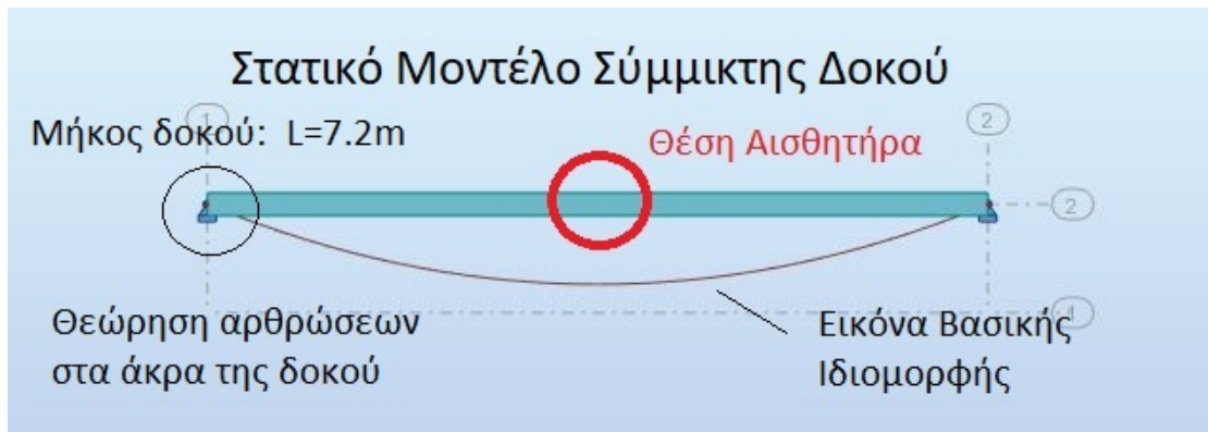
Εικόνες 4.2: Στατικό σύστημα για τις σύμμικτες δοκούς
