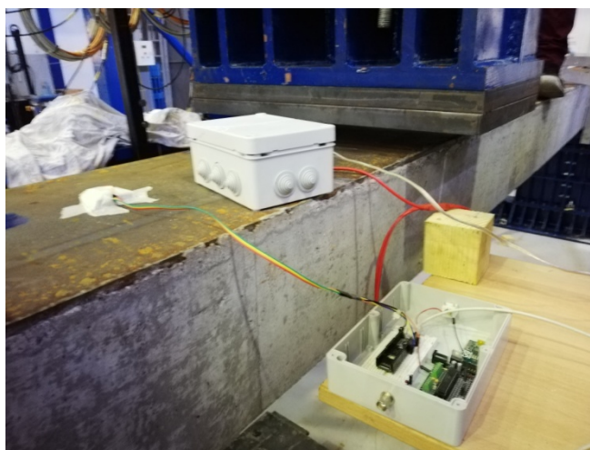
Εικόνες 4.1: Σύμμικτη δοκός στο χώρο του εργαστηρίου
