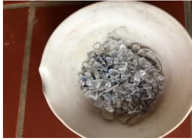
Εικόνα 19: Αποτέλεσμα έψησης στους 550 C για 30 min
