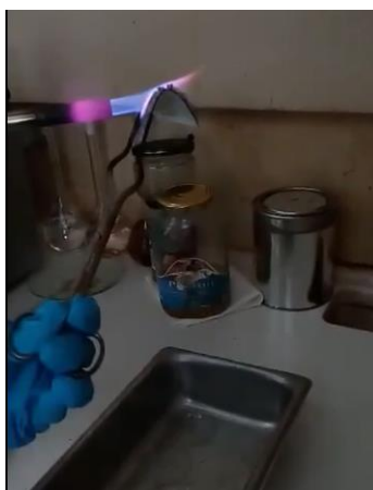
Εικόνα 11: Πάνελ σε φλόγα ασετυλίνης
