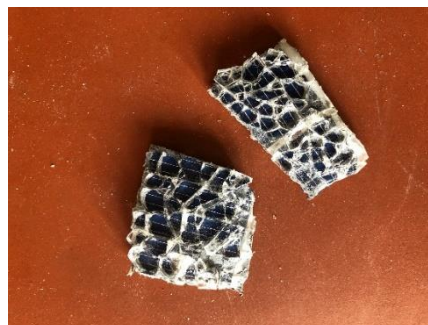
Εικόνα 9 : Φωτοβολταϊκό Πάνελ Πολυκρυσταλλικού Πυριτίου
