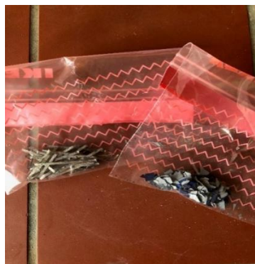
Εικόνα 20 : Αριστερά : Ηλεκτρόδια χαλκού , Δεξιά : Κομμάτια Πυριτίου
