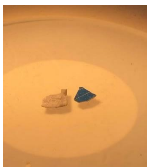
Εικόνα 26: Σύγκριση πυριτίου φωτοβολταϊκού πάνελ, πριν και μετά τον καθαρισμό. Μπροστινή όψη. ( Αριστερά, μετά από καθαρισμό, δεξιά πριν τον καθαρισμό)
