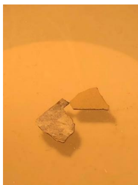
Εικόνα 27 : Σύγκριση πυριτίου φωτοβολταϊκού πάνελ, πριν και μετά τον καθαρισμό. Πίσω όψη. ( Αριστερά, μετά από καθαρισμό, δεξιά πριν τον καθαρισμό)
