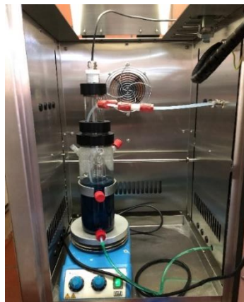
Εικόνα 17: Ο φωτοκαταλυτικός αντιδραστήρας πληρωμένος με διάλυμα methyleneblue
