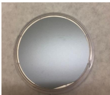
Εικόνα 13: Πλακίδιο Εμπορίου Μονοκρυσταλλικού Πυριτίου
