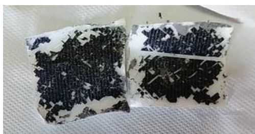
Εικόνα 18 : Αποτέλεσμα διαχωρισμού με τολουόλιο
