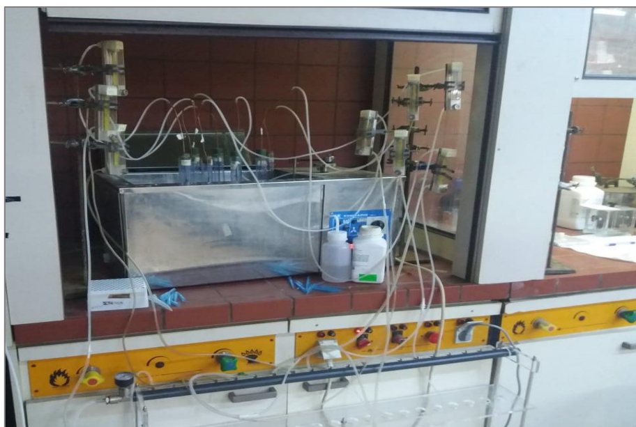
Εικόνα 2. Εργαστηριακή διάταξη αποθείωσης σε διαφασικό σύστημα
