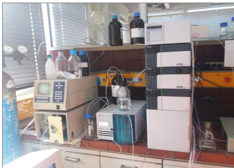
Εικόνα 3. Διάταξη εργαστηριακής συσκευής HPLC
