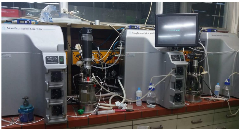
Εικόνα 1. Διάταξη Βιοαντιδραστήρων ανάπτυξης σε γλυκερόλη (αριστερά) και οξικό νάτριο (δεξιά) με πηγή S 1,3 mM DMSO
