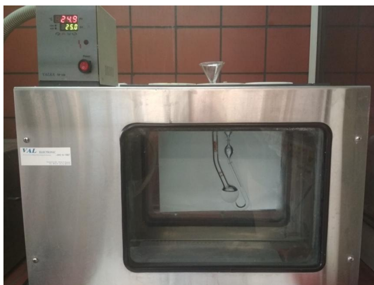
Εικόνα 26. Διάταξη υδατόλουτρου με βυθισμένο το ιξωδόμετρο στους 25°C
