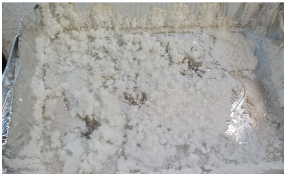
Εικόνα 30. Άλας πολυαμιδίου που παρασκευάστηκε σε υδατικό διάλυμα και
