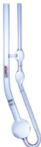
Εικόνα 27. Ιξωδόμετρο τύπου Cannon Fenske Routine, το οποίο χρησιμοποιήθηκε κατά την διεξαγωγή των πειραμάτων
