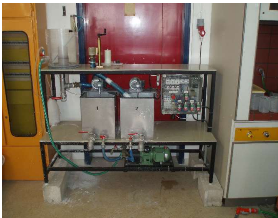
Εικόνα 39: Πιλοτική μονάδα επίπλευσης τύπου IAF (Induced Air Flotation) (Εργαστήριο Οργανικής Χημικής Τεχνολογίας, Σχολή Χημικών Μηχανικών, Ε.Μ.Π., 2009)
