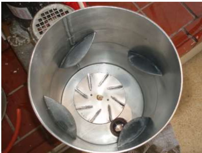
Εικόνα 38: Εσωτερικό πολτοποιητή Maelstrom (Εργαστήριο Οργανικής Χημικής Τεχνολογίας, Σχολή Χημικών Μηχανικών, Ε.Μ.Π., 2009)
