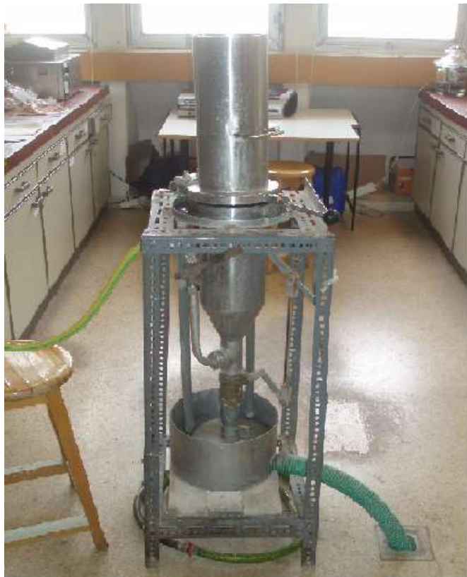
Εικόνα 41: (α) Εργαστηριακή φυλλοποιητική συσκευή του Οίκου Lorentzen & Wettre (Σουηδία), τύπου SCA (Εργαστήριο Οργανικής Χημικής Τεχνολογίας, Σχολή Χημικών Μηχανικών, Ε.Μ.Π., 2009) (β) Σχηματική παρουσίαση της φυλλοποιητικής συσκευής
