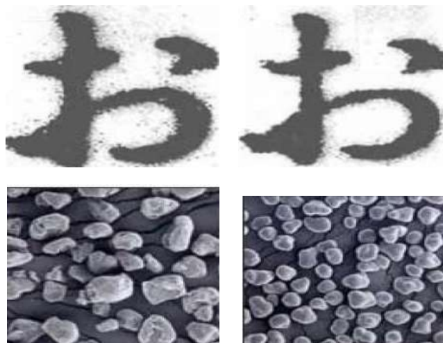
Εικόνα 30: Σύγκριση συμβατικού (εικόνες στα αριστερά) και χημικώς επεξεργασμένου toner (εικόνες στα δεξιά). Τα σωματίδια του χημικώς επεξεργασμένου είναι μικρότερα από αυτά του συμβατικού (Μεγέθυνση της μικροφωτογραφίας x 1.000) (Fluharty 2008, Fluharty 2005).
