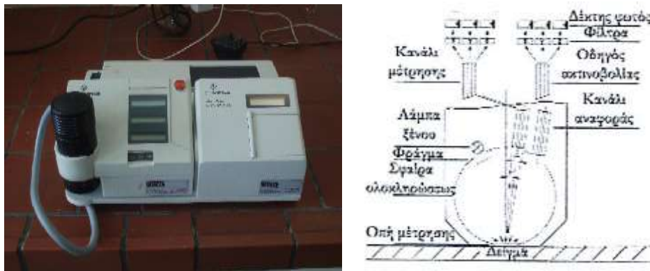
Εικόνα 43: (α) Χρωματόμετρο DR. Lange, μοντέλου Micro Color (β) Οπτική δομή χρωματόμετρου, (Εργαστήριο Οργανικής Χημικής Τεχνολογίας, Σχολή Χημικών Μηχανικών, Ε.Μ.Π., 2007)
