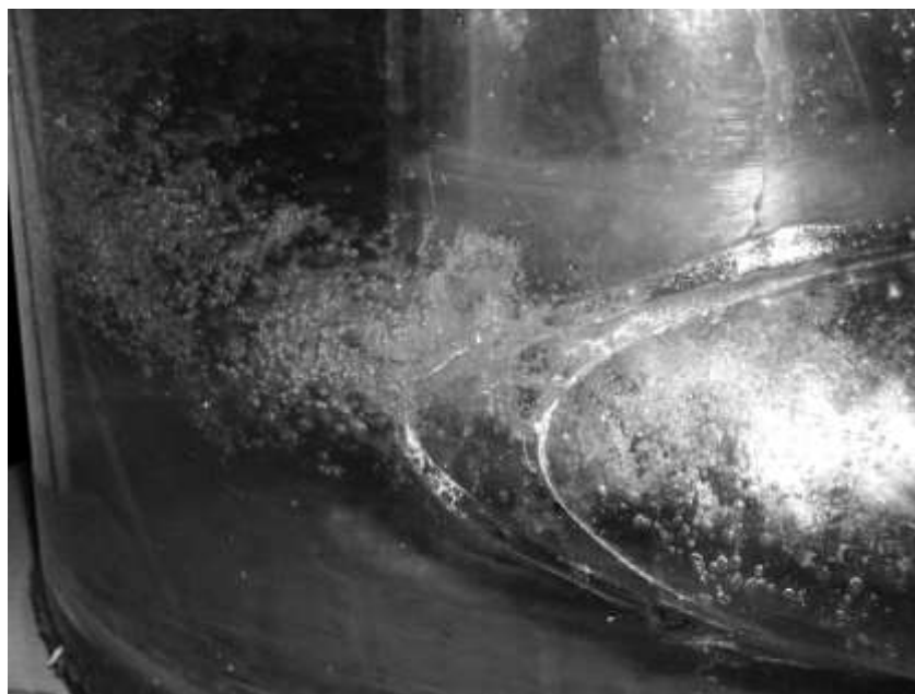
Εικόνα 40: Ασπρόμαυρη εικόνα των φυσαλίδων αέρα που εισάγονται στο κελί επίπλευσης (Εργαστήριο Οργανικής Χημικής Τεχνολογίας, Σχολή Χημικών Μηχανικών, Ε.Μ.Π., 2009)
