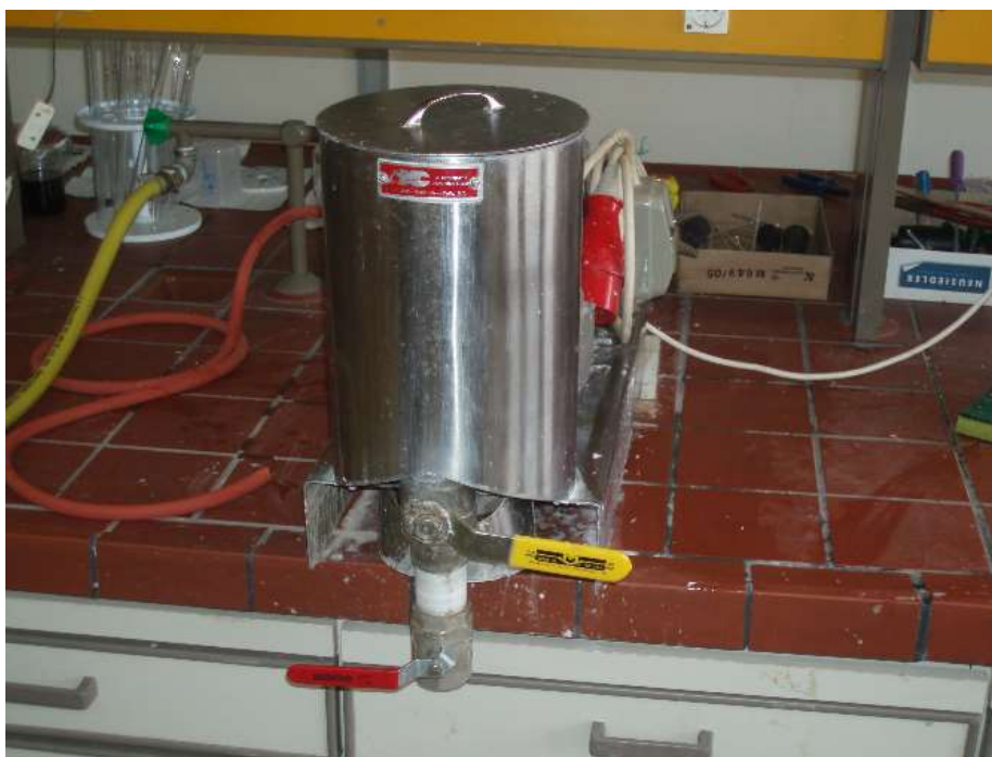
Εικόνα 37: Πολτοποιητής Maelstrom (Εργαστήριο Οργανικής Χημικής Τεχνολογίας, Σχολή Χημικών Μηχανικών, Ε.Μ.Π., 2009)
