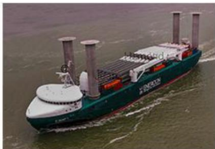
Εικόνα 12. Το E-Ship 1 που χρησιμοποιεί ρότορες Flettner
