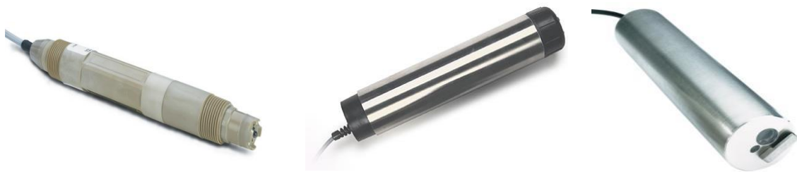
Εικόνα 6.4: Ψηφιακά όργανα μέτρησης pH, DO, MLSS πιλοτικής εγκατάστασης.
