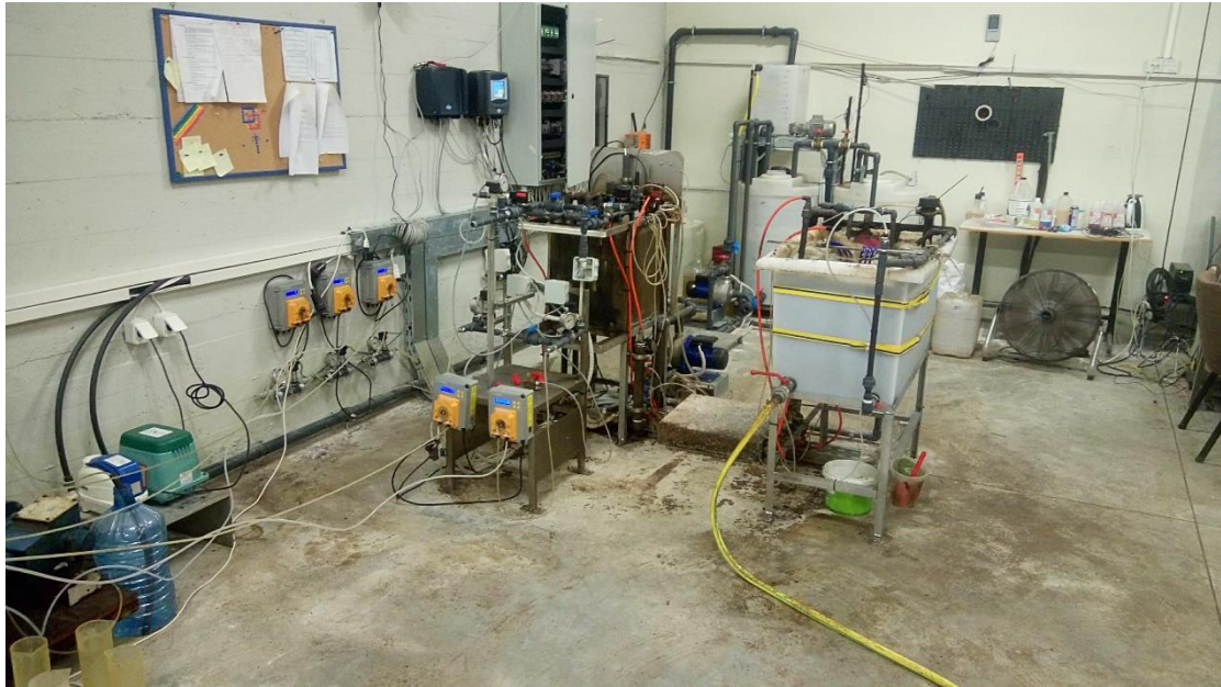
Εικόνα 6.5 Διάταξη συστήματος MBR επεξεργασίας αποβλήτων
