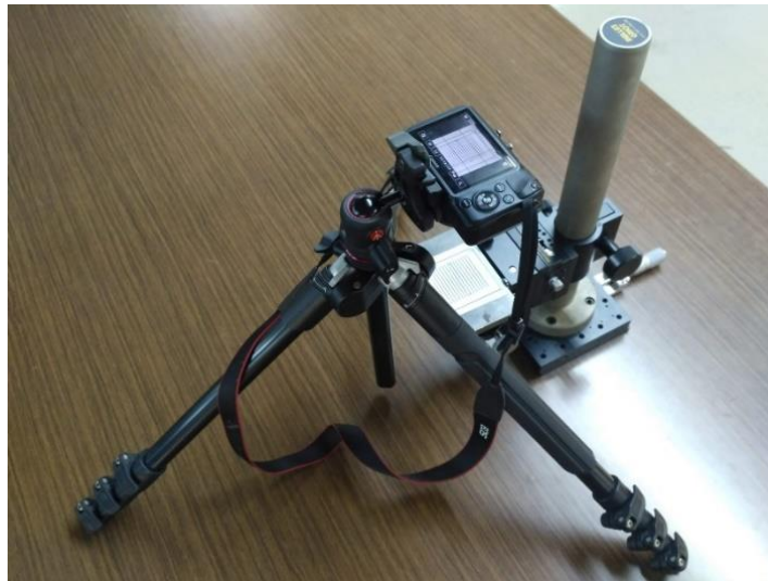
Σχήμα 5-2 Διάταξη μέτρησης των δοκιμίων που περιλαμβάνει πλατφόρμα μεταβλητού ύψους και γωνίας περιστροφής, φωτογραφική μηχανή και τρίποδο στήριξης.
