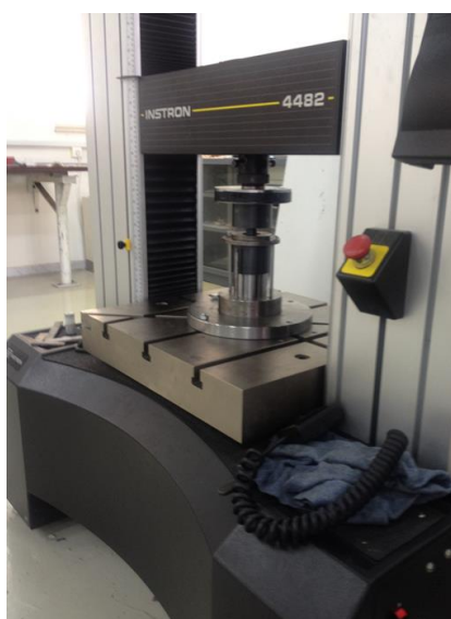
Σχήμα 4.2-4: Πρέσα δοκιμών INSTRON 4482, ονομαστικού φορτίου 100 KN.
