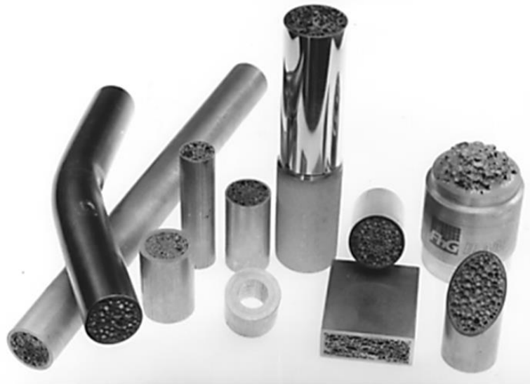
Σχήμα 1.1-14: Σωλήνες γεμισμένοι με αφρό αλουμινίου. (“Fraunhofer IFAM / English - Fraunhofer IFAM,” n.d.)
