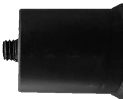
Σχήμα 3.2-6: Εργαλείο FSP που χρησιμοποιήθηκε στην πειραματική διαδικασία.
