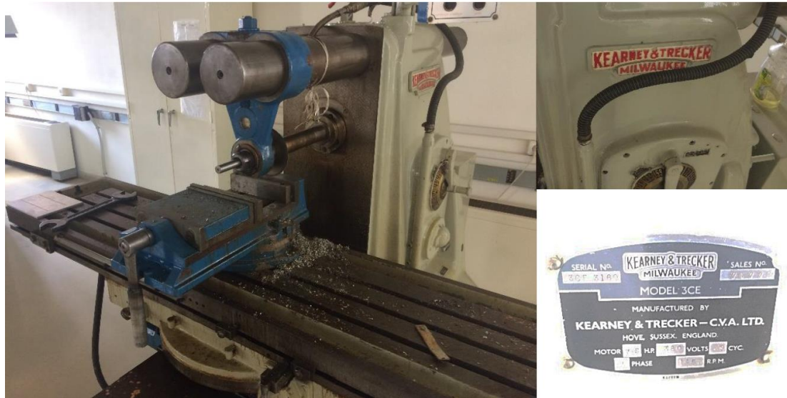
Σχήμα 3.2-7: Εργαλειομηχανή φρέζας Kearny & Trecker 3CE.
