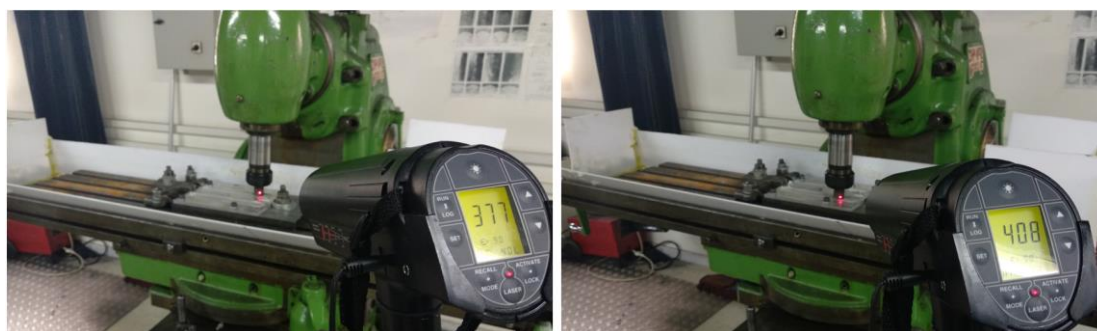
Σχήμα 3.3-6: Μέτρηση θερμοκρασίας FSP, αριστερά σετ παραμέτρων FSP 750 rpm, δεξιά σετ παραμέτρων FSP 1000 rpm.
