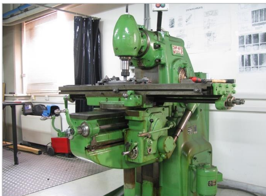
Σχήμα 3.2-5: Μηχανή συγκόλλησης δια τριβής με ανάδευση.
