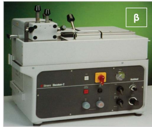
Σχήμα 3.2-16: (a) Αυτόματο πρίονι Rich Young CY350, (b) δισκοτόμος Struers Discotom-2.
