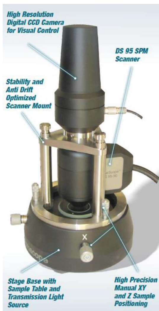
Σχήμα 3.2-20: Μικροσκόπιο Ατομικής Δύναμης DME Igloo DS 95 with SPM Head.
