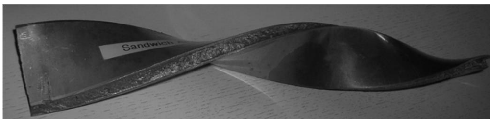
Σχήμα 1.1-5: Δομή τύπου σάντουιτς με πυρήνα από αφρό αλουμινίου. (Banhart and Seeliger, 2008)
