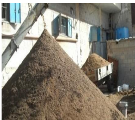
Σχήμα 3. Στερεό παραπροϊόν (ελαιοπυρήνας) και υγρά απόβλητα από τη διαδικασίας παραγωγής ελαιόλαδου από τριφασικό σύστημα φυγοκέντρησης
