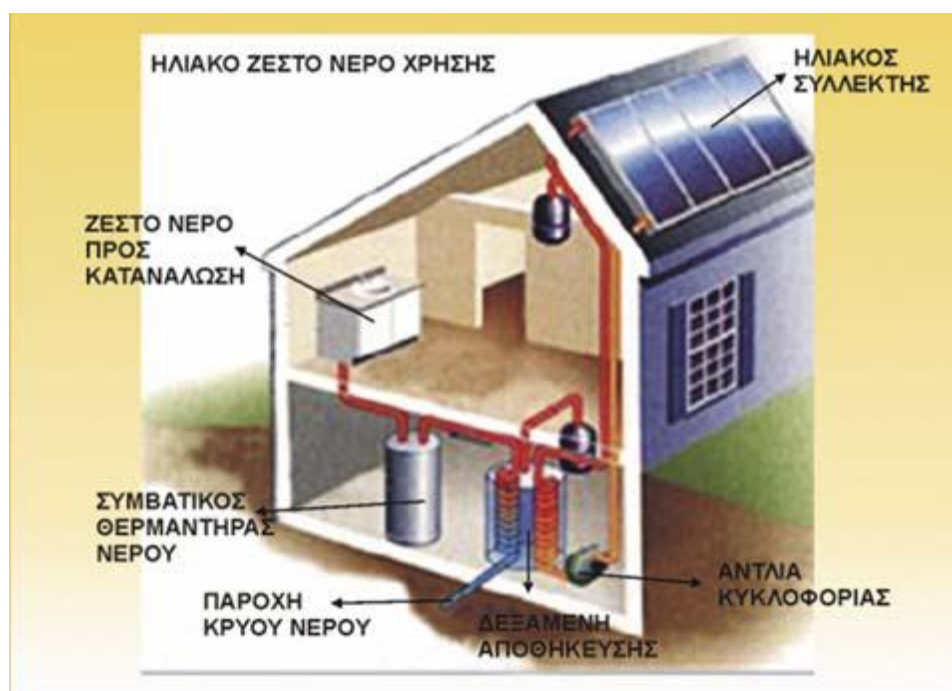
Σχήμα 8.1.1: Οικιακή εγκατάσταση για ζεστό νερό χρήσης. [165]
