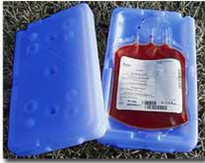
Σχήμα 4.10.1: Υλικά αλλαγής φάσης για μεταφορά αίματος. [116]
