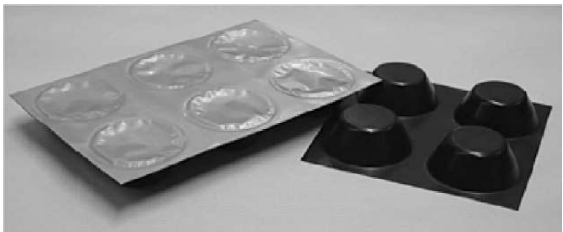
Σχήμα 1.5.3.3: Μακροενσωμάτωση PCMs σε λωρίδες καψουλών για ανόργανα PCMs. [15]
