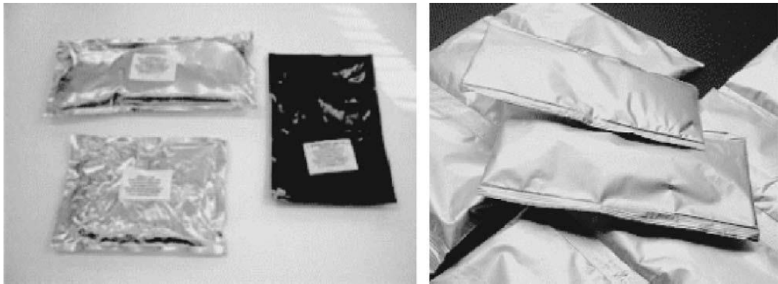
Σχήμα 1.5.3.2: Μακροενσωμάτωση PCMs σε θήκες. [15]
