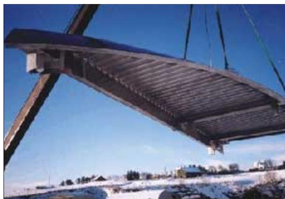
Εικόνα 31: Προκατασκευασμένο με FSW ενισχυμένο έλασμα, προορισμένο για υπερκατασκευή κρουαζιερόπλοιου (για το ήμισυ του ολικού πλάτους της) (από [35]).
