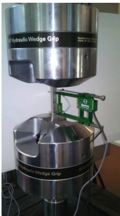
Εικόνα 85: Η υδραυλική μηχανή μηχανικών δοκιμών της MTS. Στο υπό μελέτη δοκίμιο παρατηρείται τοποθετημένο το επιμηκυσσιόμετρο της «Epsilon».
