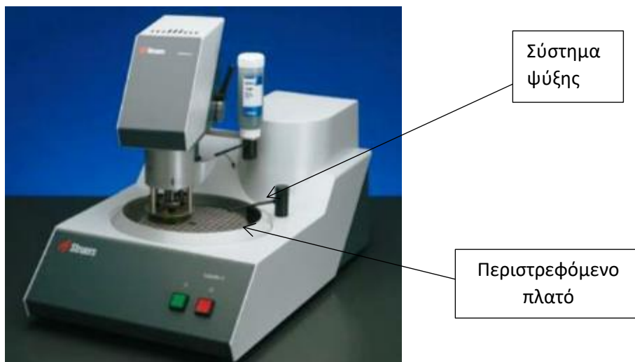
Εικόνα 80: Διάταξη στην οποία πραγματοποιείται η λείανση και η στίλβωση των προς μελέτη δοκιμίων.
