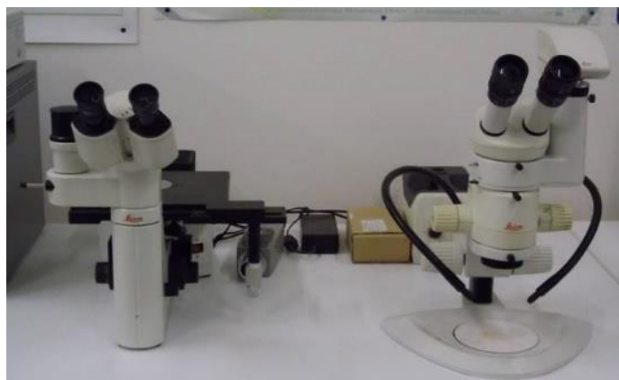
Εικόνα 81: Εξοπλισμός οπτικής μικροσκοπίας του Εργαστηρίου Ναυπηγικής Τεχνολογίας. Αριστερά: Οπτικό μικροσκόπιο τύπου «Leica DMILM». Δεξιά: Οπτικό στερεοσκόπιο τύπου «Leica MZ6».
