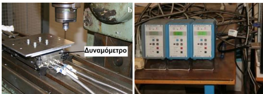
Εικόνα 77: α) Το δυναμόμετρο (KISTLER) ενσωματωμένο στη μηχανή συγκόλλησης με τις προς συγκόλληση πλάκες κατάλληλα συγκρατημένες πάνω σε αυτό, (β) οι ενισχυτές σήματος.
