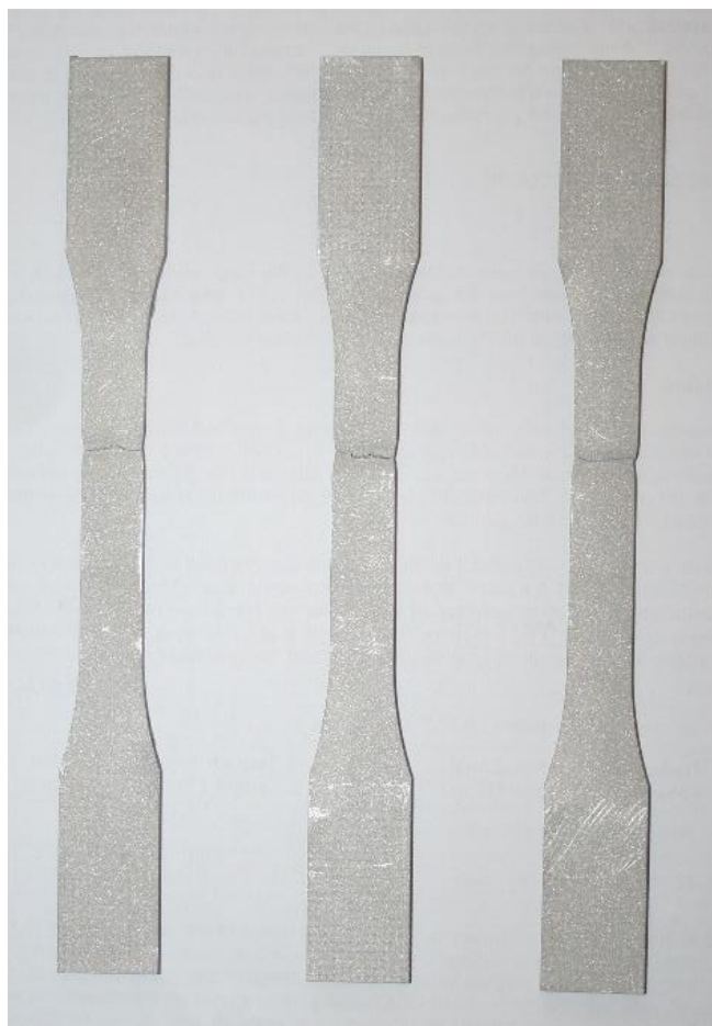
Εικόνα 181: Τα τρία δοκίμια εφελκυσμού της FSW του AA6082 μετά τη θραύση τους.
