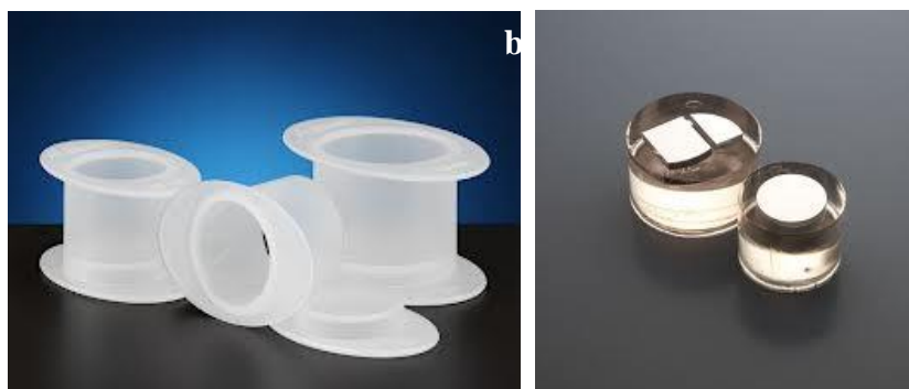
Εικόνα 79: α) Ειδικά καλούπια για την πραγματοποίηση του εγκιβωτισμού και β) εγκιβωτισμένα δοκίμια.
