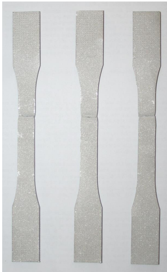
Εικόνα 200: Τα τρία δοκίμια εφελκυσμού της FSW του AA6082 με ενίσχυση SiC μετά τη θραύση τους.
