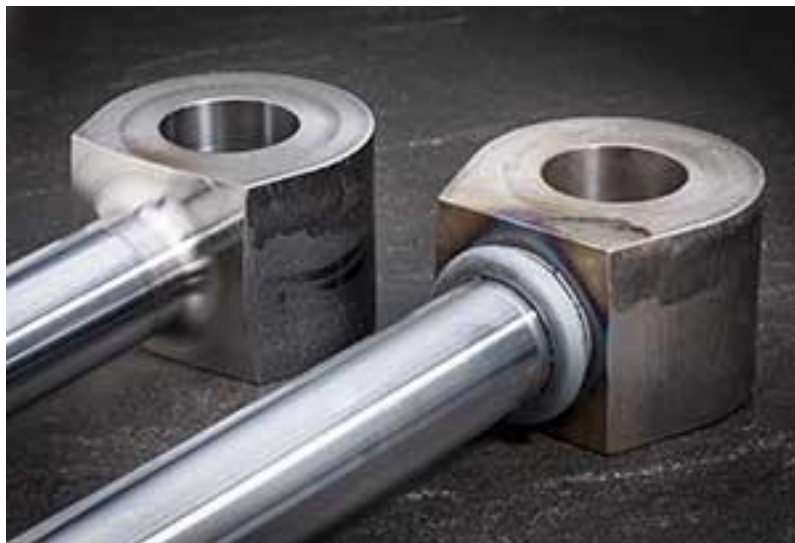
Εικόνα 2: Εξαρτήματα τα οποία έχουν συγκολληθεί με τη μέθοδο δια τριβής με περιστροφή. Στο δεξί παρατηρείται η υπερχειλίση υλικού στις άκρες ενώ στο αριστερό έχει αφαιρεθεί με κοπή.
