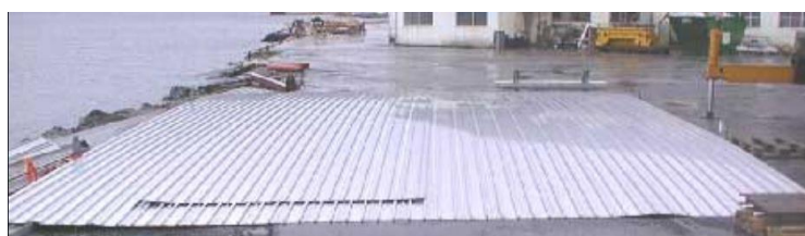
Εικόνα 33: Ενισχυμένο έλασμα όπου οι συγκολλήσεις έχουν γίνει με τη μέθοδο FSW, έτοιμο για θαλάσσια μεταφορά (από [36]).
