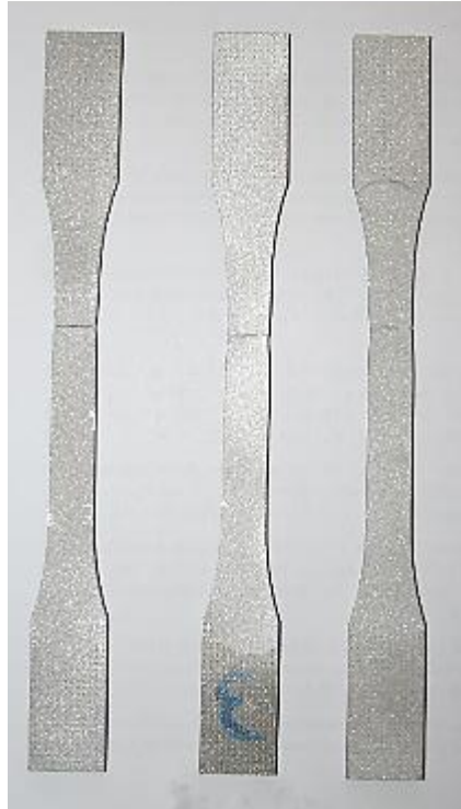
Εικόνα 122: Τα τρία δοκίμια εφελκυσμού της FSW του AA5083 μετά τη θραύση τους.
