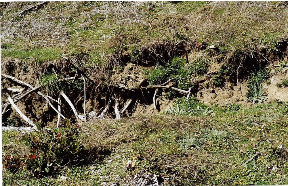
Σχήμα 3.9: Εικόνα της κύριας ρηγματώσεως πίσω από το μέτωπο (14 μήνες μετά την κατολίσθηση).
