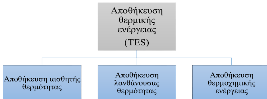
Εικόνα 4.4.1: Τρόποι αποθήκευσης θερμικής ενέργειας.
