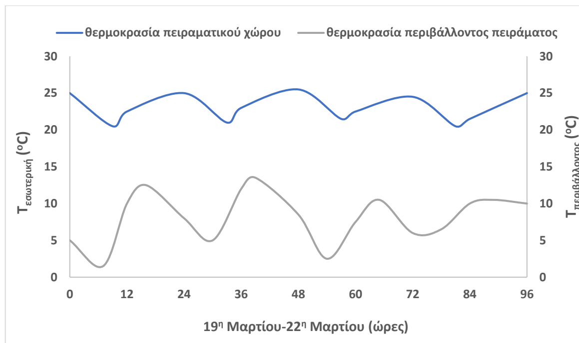
Διάγραμμα 7.2.3: Διακύμανση εξωτερικής θερμοκρασίας και εσωτερικής θερμοκρασίας πειραματικού χώρου με πλάκα PCM στο δάπεδο μέσω πειράματος.
