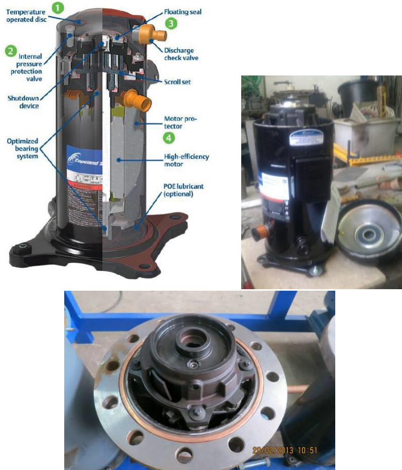
Εκτονωτής τύπου Scroll, κοπή κεφαλής και πρόσβαση στο εσωτερικό
