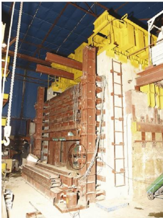
Εικόνα 4.1: Το εργαστηριακό μοντέλο με την τυπική διατομή της σήραγγας προσομοίωσης.
