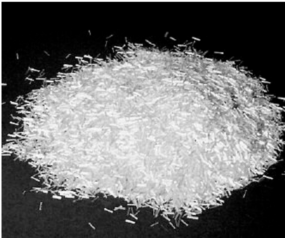
Εικόνα 25 Ίνες S-glass fibers, [A11]
