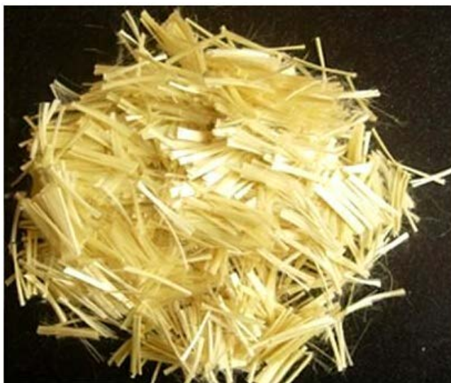
Εικόνα 26 Ίνες αραμιδίου, [A11]
