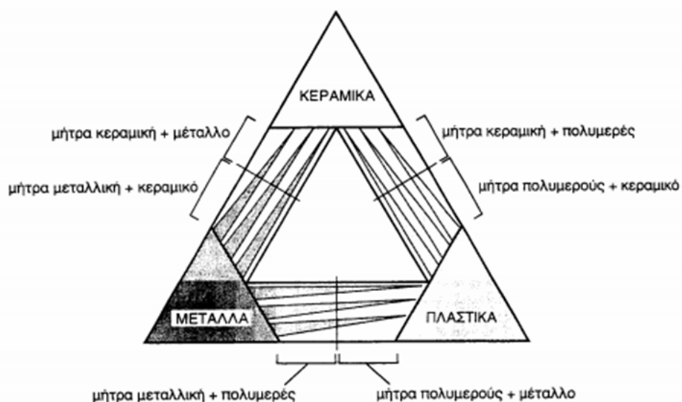
Εικόνα 23 Οικογένειες σύνθετων υλικών, [A4]
