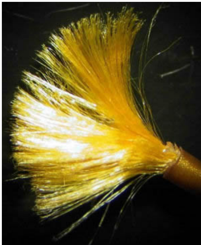
Εικόνα 28 Ίνες Zylon, [A11]
