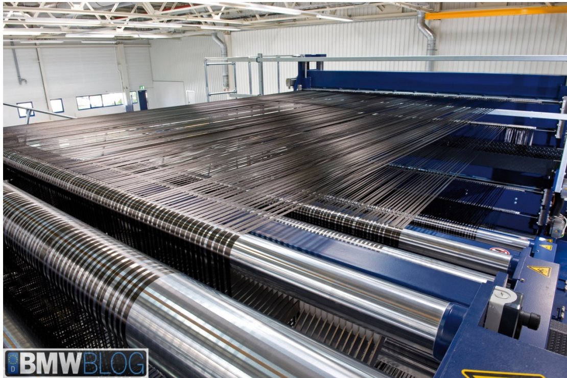
Εικόνα 30 Παραγωγή ινών άνθρακα, [B34]
