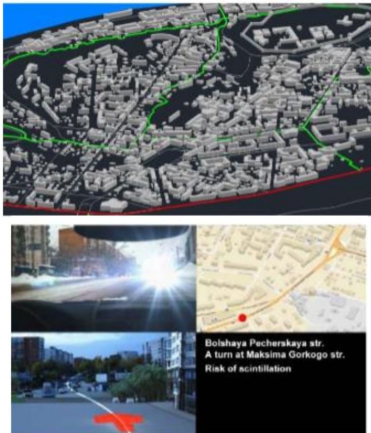
Εικόνα 1.22: 3D σύστημα για την αποφυγή της μειωμένης όρασης στην οδήγηση
