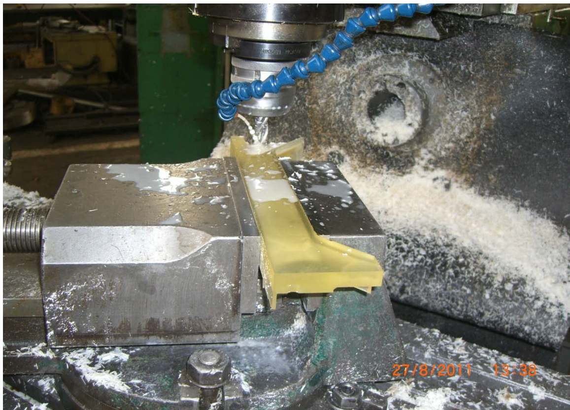
Εικόνα 5.11 Ξεχόνδρισμα του δεύτερου καναλιού της δοκού
