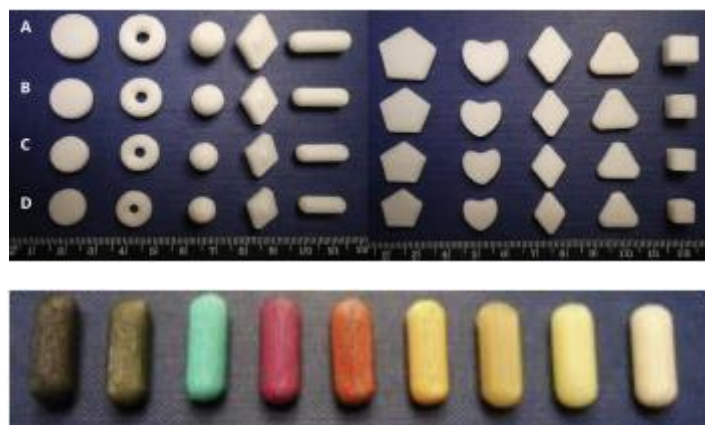
Σχήμα 3.5: Ποικιλία σχεδίων, μεγεθών, χρωμάτων των 3D εκτυπωμένων χαπιών [49]
