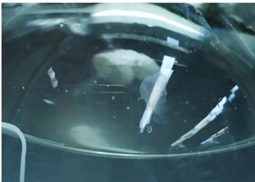
Σχήμα 8.1: Αστοχία του φορέα και διαφυγή της σκόνης στο διάλυμα
