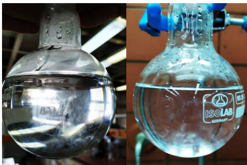
Σχήμα 8.2: Η μορφή της υδρογέλης σε όξινο (αριστερά) και βασικό (δεξιά) περιβάλλον
