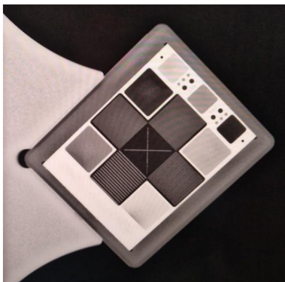
Εικόνα 13α: DRR (Digitally Reconstructed Radiograph) για kV=60 και mAs=1.68 στον γραμμικό επιταχυντή VitalBeam1 (Ημερομηνία λήψης: 18/12/2019)
