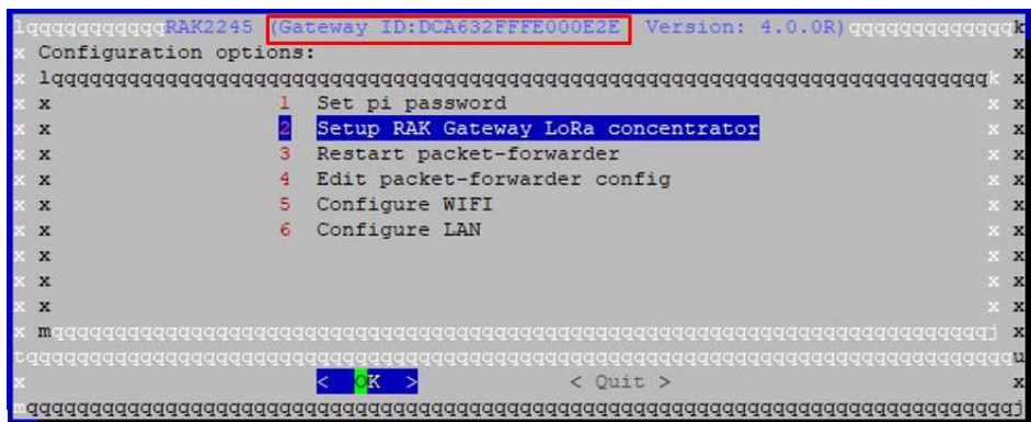
Σχήμα 31: Αρχικό Μενού Gateway μέσω SSH
