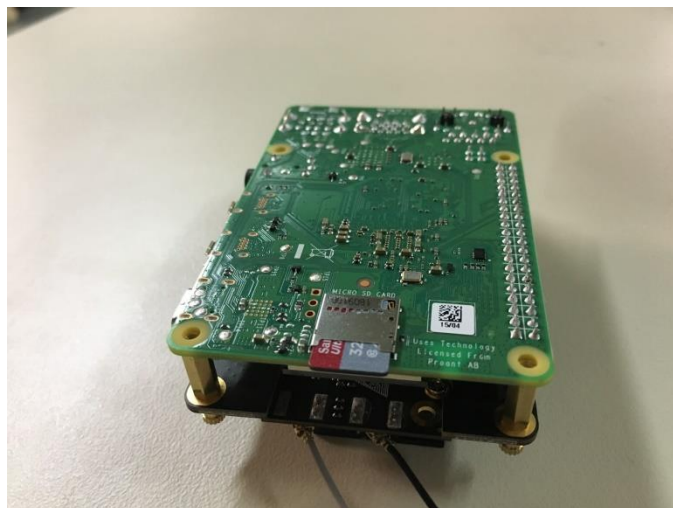
Σχήμα 22: Τοποθέτηση κάρτας MicroSD
