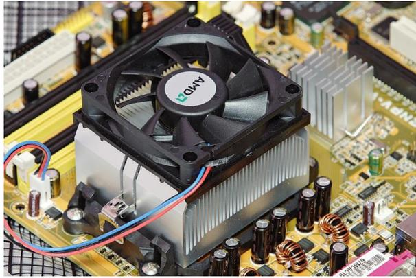
*Σχήμα 19: Μια ψύκτρα ψύξης με πτερόγυια με ανεμιστήρα που έχει συνδεθεί σε CPU, με μικρότερη παθητική ψύκτρα χωρίς ανεμιστήρα στο παρασκήνιο.*
