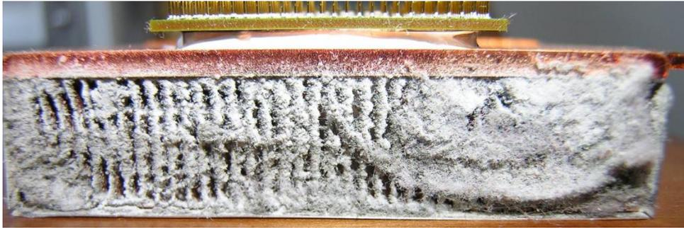
*Σχήμα 20: Η συσσώρευση σκόνης σε ψύκτρα CPU φορητού υπολογιστή.[74]*
