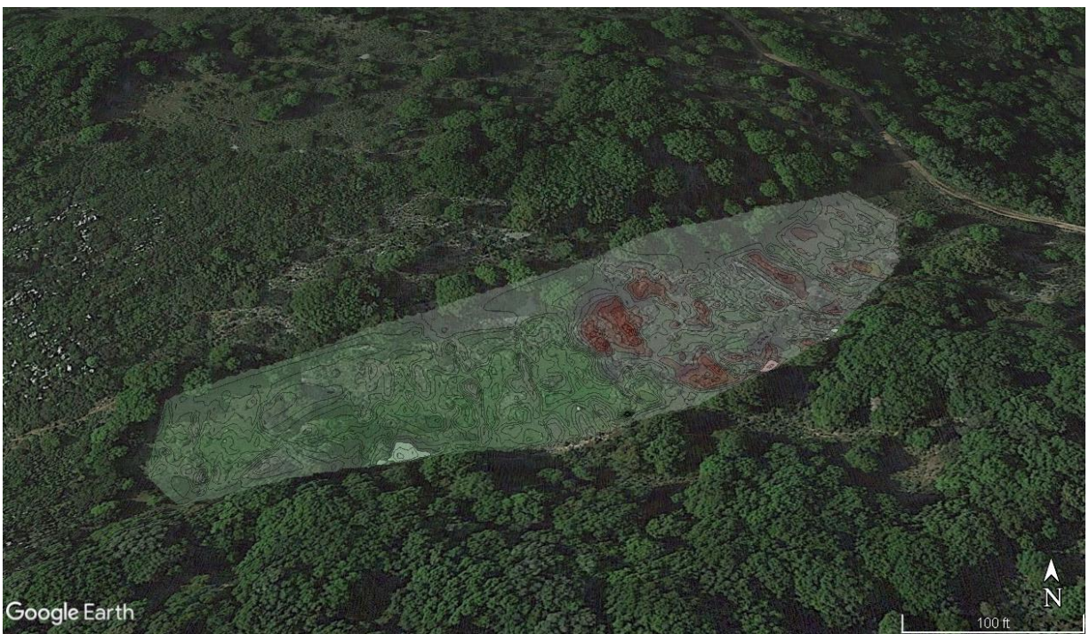
Εικόνα 5.11: Χάρτης κατανομής της ηλεκτρικής αγωγιμότητας για συνολικό βάθος διασκόπησης 3 m, απαλλαγμένος από ανωμαλίες μέχρι το 1,5 m και τοποθετημένος στο Google Earth.
