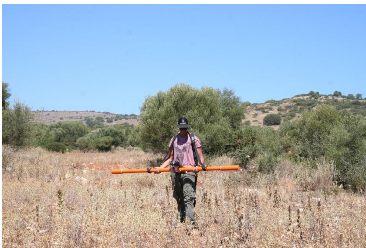
Εικόνα 5.4: Ηλεκτρομαγνητικές μετρήσεις με τη χρήση οργάνου CMD-2
