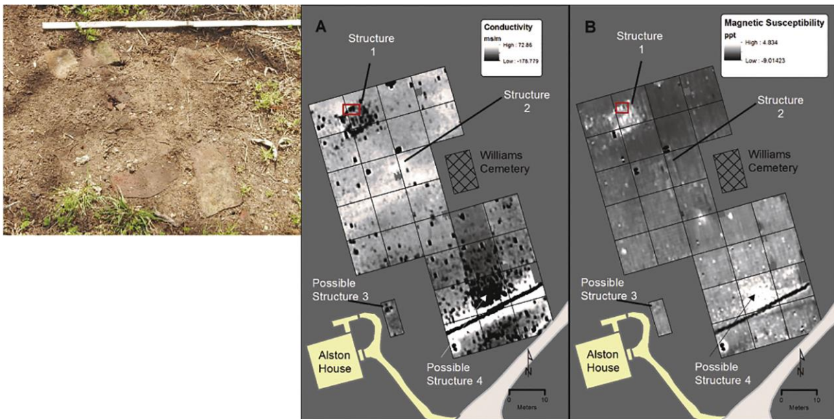
Εικόνα 3.26: Υπολείμματα θεμελίωσης της Δομής Ένα που ανιχνεύτηκαν από τους χάρτες αγωγιμότητας και μαγνητικής επιδεκτικότητας.
