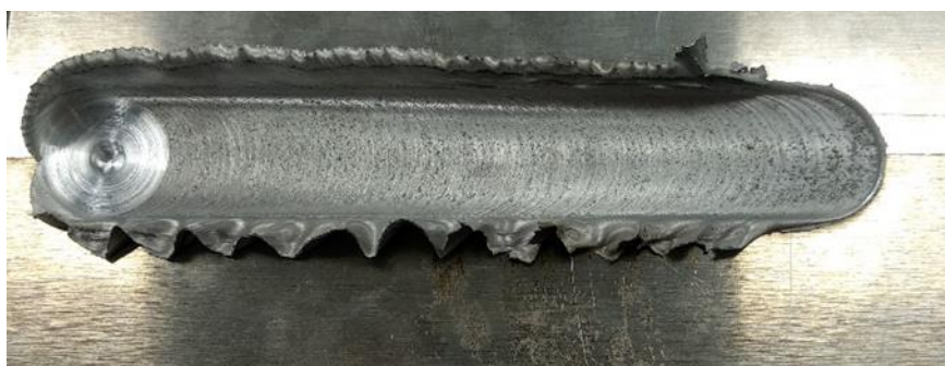
Εικόνα 38 S3: Air με ταχύτητα περιστροφής1000 rpm, ταχύτητα πρόωσης 32 mm/min
