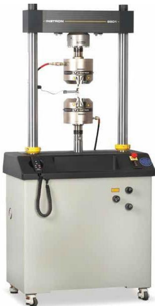
Εικόνα 31 Μηχανή κόπωσης τύπου Instron 8800
