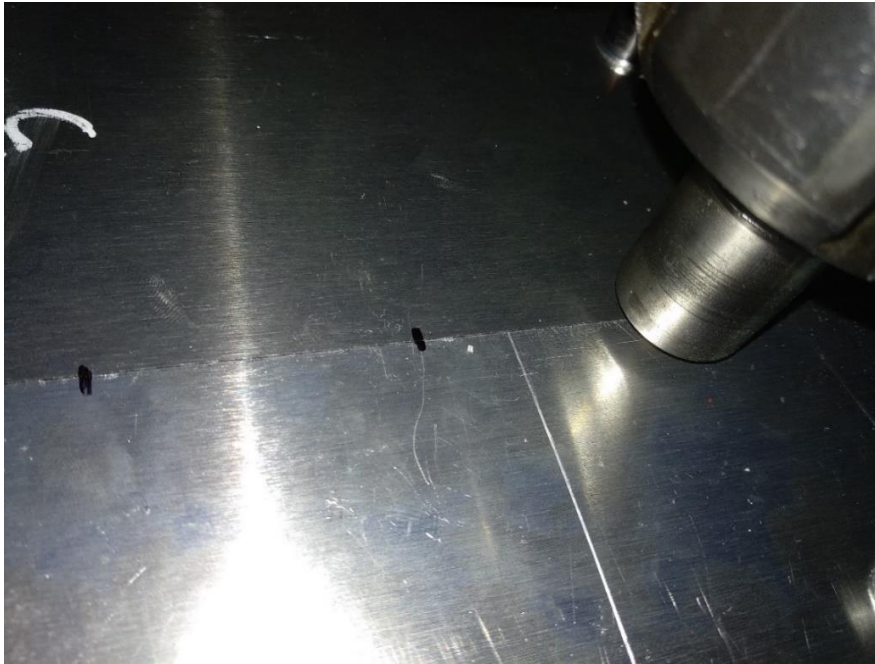
Εικόνα 25 Ευθυγράμμιση του εργαλείου με τα δοκίμια ώστε να διέρχεται ακριβώς πάνω από την ένωση.
