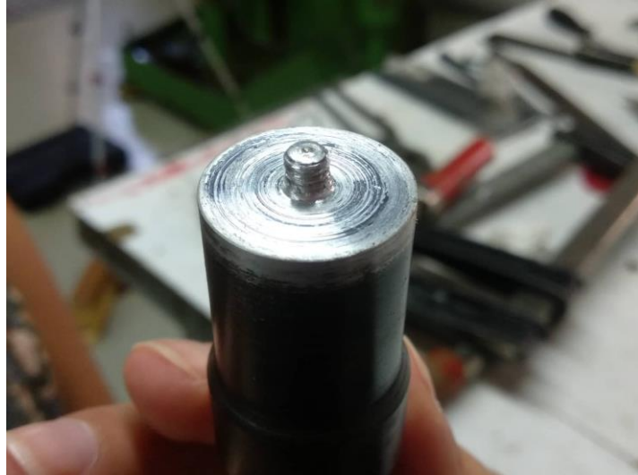
Εικόνα 23 Το εργαλείο συγκόλλησης που χρησιμοποιήθηκε κατά την συγκόλληση και διαθέτει σπείρωμα για την καλύτερη ροή του υλικού.
