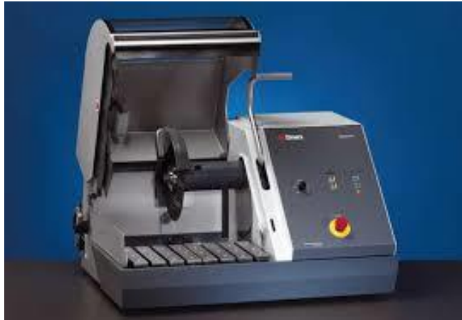
Εικόνα 27 Δισκοτόμος Struers Discotom 50.
