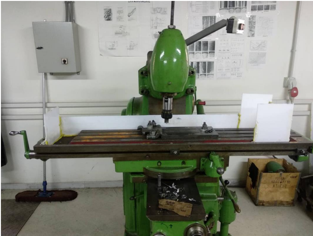
Εικόνα 21 Μηχανή συγκόλλησης δια τριβής και ανάδευσης τροποποιημένη με πισίνα για την πραγματοποίηση της μεθόδου UFSW
