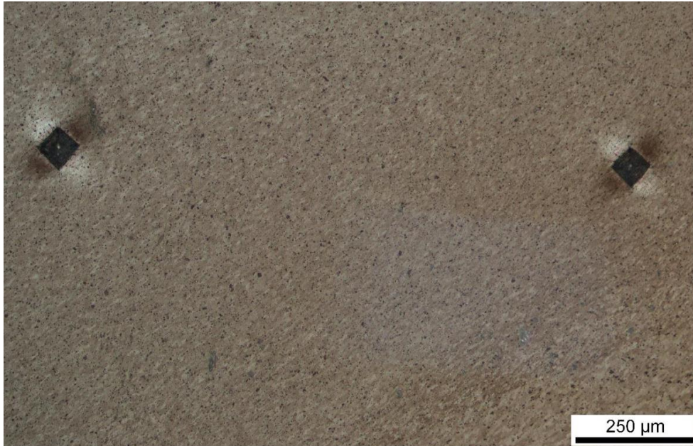
Εικόνα 32 Αποτύπωμα δοκιμών μικροσκληρομέτρησης
