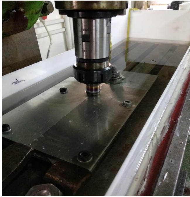
Εικόνα 26 Προετοιμασία της μεθόδου UFSW
