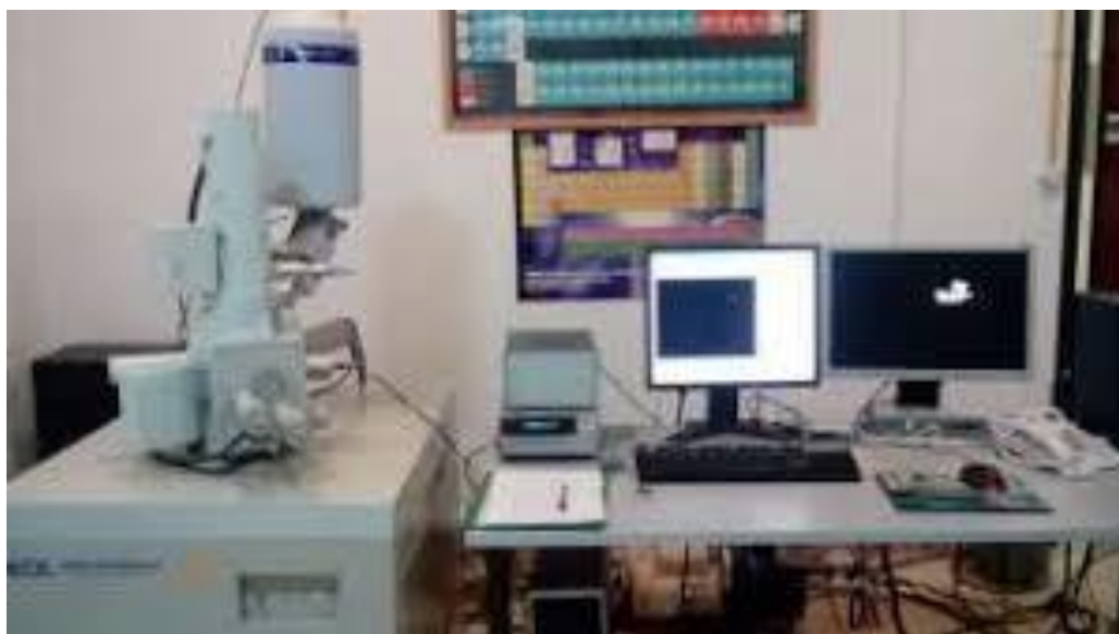
Εικόνα 34 Ηλεκτρονικό μικροσκόπιο σάρωσης (Scanning Electron Microscopy) Jeol6380LV του οίκου JEOL
