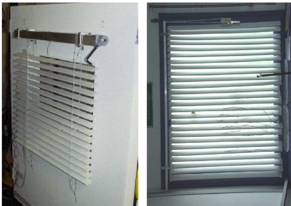
Σχήμα 7.4.1 Σκίαστρα με ενσωματωμένα PCMs.
