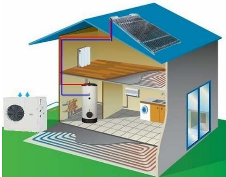
Σχήμα 4.2 Τυπικό ενεργητικό ηλιακό σύστημα [9].
