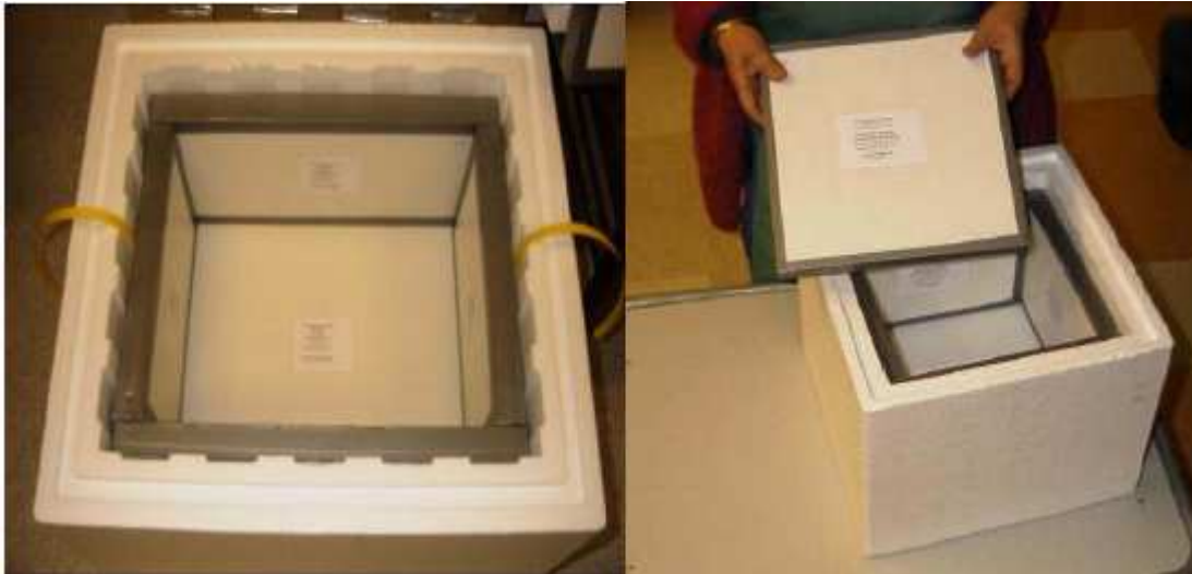
Σχήμα 5.4.1 Πλάκες με PCM για ενίσχυση των δοχείων μεταφοράς ευαίσθητων προϊόντων [24].
